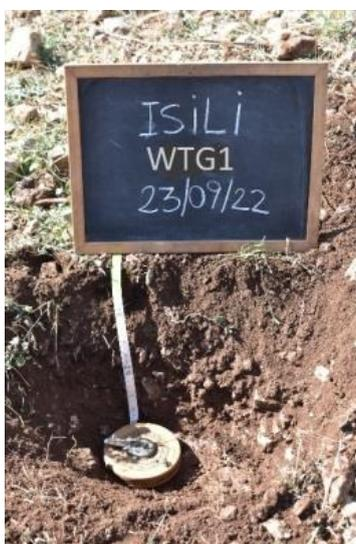
Il sito in cui è prevista l'installazione dell'aerogeneratore WTG1 ricade geologicamente sulla Formazione di Dorgali composta da dolomie, dolomie arenacee e calcari dolomitici a quota di 534m s.l.m. Morfologicamente si inserisce nella parte alta di un rilievo collinare.
