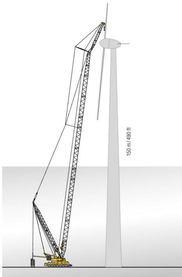
*Figura 5.17 – Schema di una gru cingolata a traliccio con sistema derrick impiegata per l'innalzamento delle turbine eoliche dell'ultima generazione*
