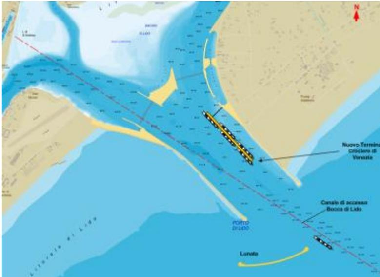
del pontile ad una distanza, in asse allo stesso, di circa 735 m dal fanale delle diga Nord. Per quanto riguarda la distanza "al traverso" del pontile verso la stessa diga, è stato assunto un distacco di 220 m con la riserva di incrementare tale tratto dopo aver concordato con la
