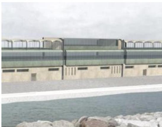
particolare della Bocca di Lido. Tali verifiche hanno portato a riconsiderare le altezze dei tre piani in elevazione rispetto all'estradosso del pontile, al fine di mitigare l'impatto visivo. Di conseguenza il progetto strutturale ha recepito tali indicazioni minimizzando l'altezza delle strutture e adattando gli impianti alle nuove geometrie. Anche la sistemazione lungo il
