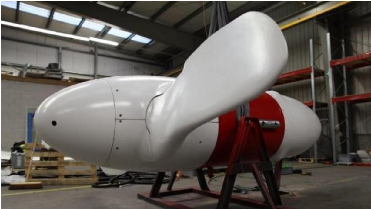
Tali impianti sono costituiti da un rotore ad elica, immerso sotto il pelo dell'acqua, e da generatori fissi (non “inseguono” la direzione delle maree) e reversibili, per sfruttare le correnti in entrambe le direzioni. Impianti di questo tipo sono già utilizzati con successo nel Mare del Nord.
