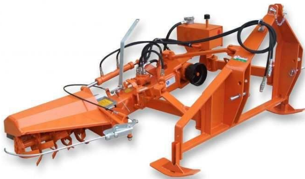
Figura 13: Esempio di fresatrice interceppo per le lavorazioni sulla fila.
