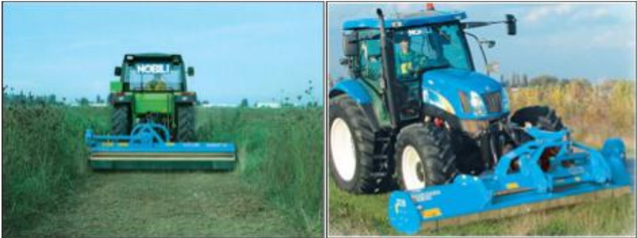
Figura 16: Esempi di trincia posteriore e anteriore di notevole larghezza.
