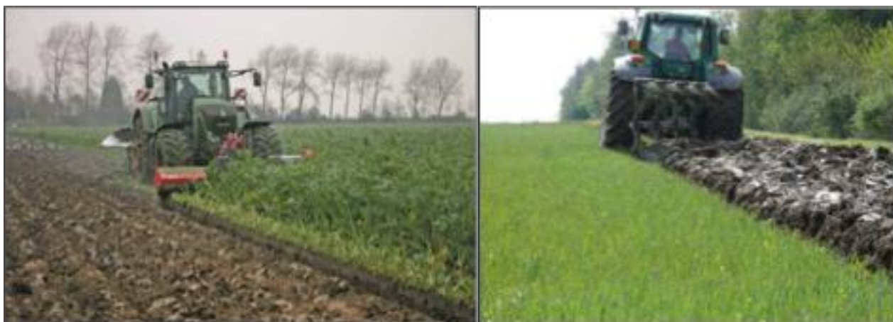
Figura 14: Esempio di pratica del sovescio in pieno campo. Si noti, a sinistra, l'impiego di una trincia frontale montata sulla stessa trattrice per alleggerire il carico sull'aratro portato.
