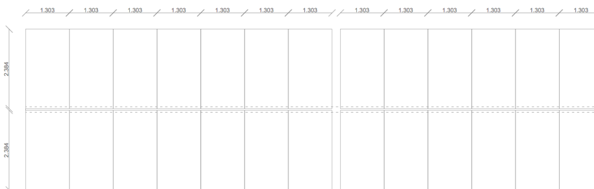
Figura 3: Dettaglio Tracker Tipologia 2V (moduli 28x2) - pianta.
