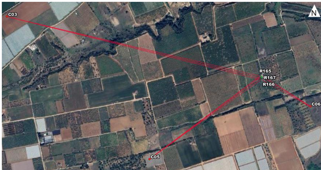
Figura 3-41 Localizzazione ricettori R165, R166 e R167 rispetto agli aerogeneratori che causano l'effetto dello shadow flickering
