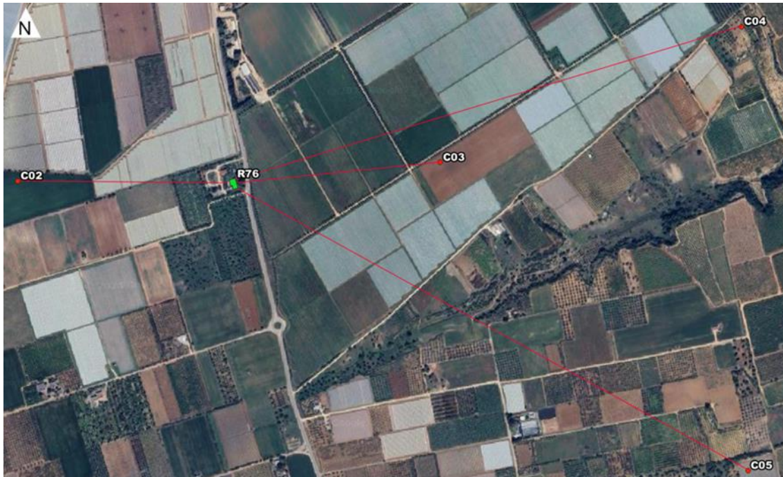
Figura 3-31 Localizzazione ricettore R76 rispetto agli aerogeneratori che causano l'effetto dello shadow flickering
