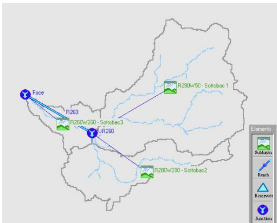
Figura 93: Schema idrologico del bacino idrografico utilizzato per il calcolo della massima portata al colmo di piena. È stato condotto uno studio delle piogge al fine di calcolare i parametri statistici necessari per la costruzione delle curve di probabilità pluviometrica per l'intero bacino in esame. Per la determinazione della pioggia netta, o deflusso
