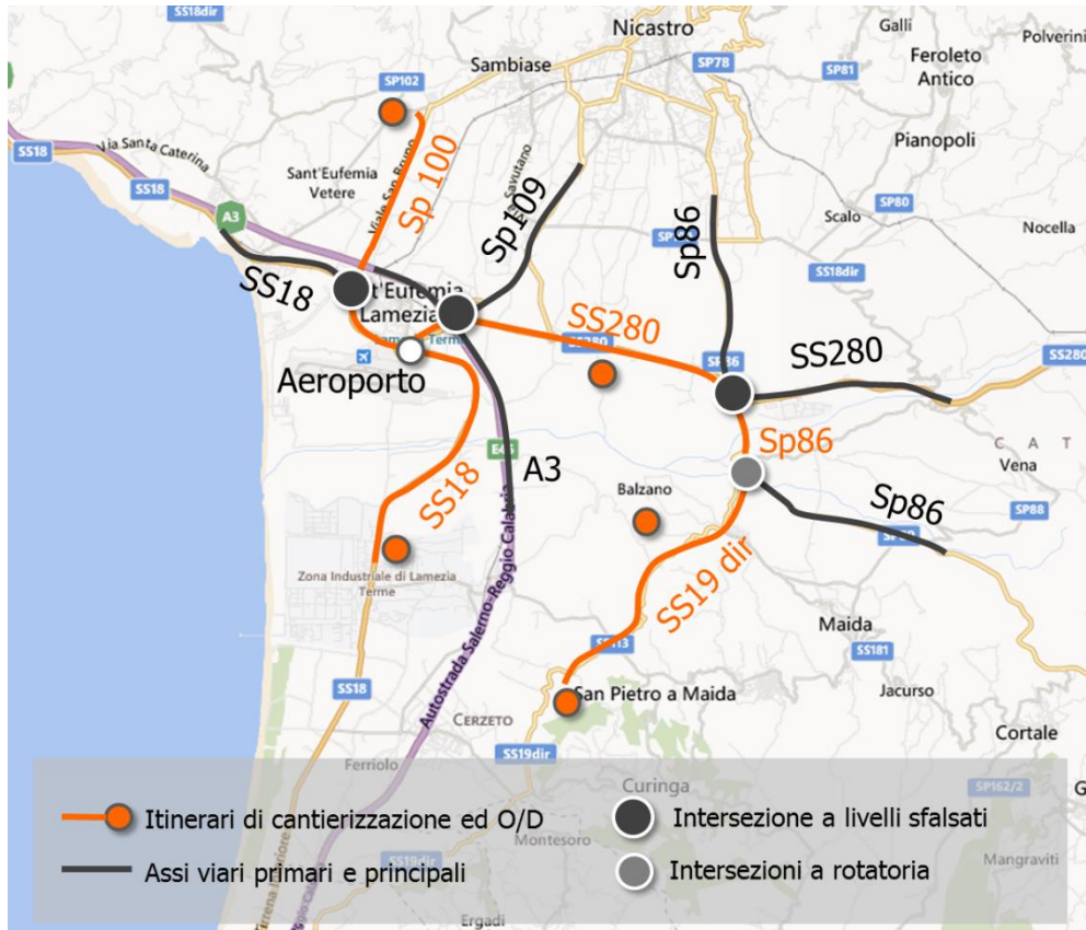
Figura 4-13 Intersezioni tra viabilità primaria/orincipale e quella interessata dai flussi di cantierizzazione
