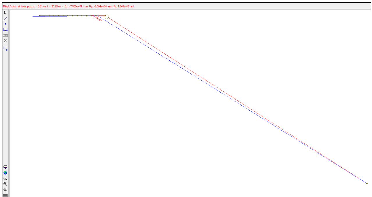
Figura 4-17 Caso di carico 3) – Deformata (fattore di scala 10)
