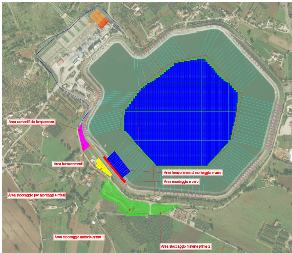
Figura 4-4: Aree di cantiere e di installazione
