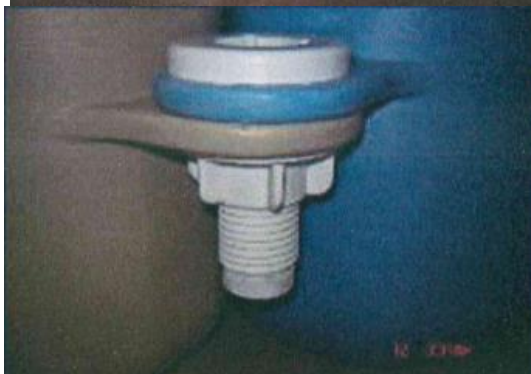
Figura 6-3: Installazione dei connettori laterali (2 unità collegate)
