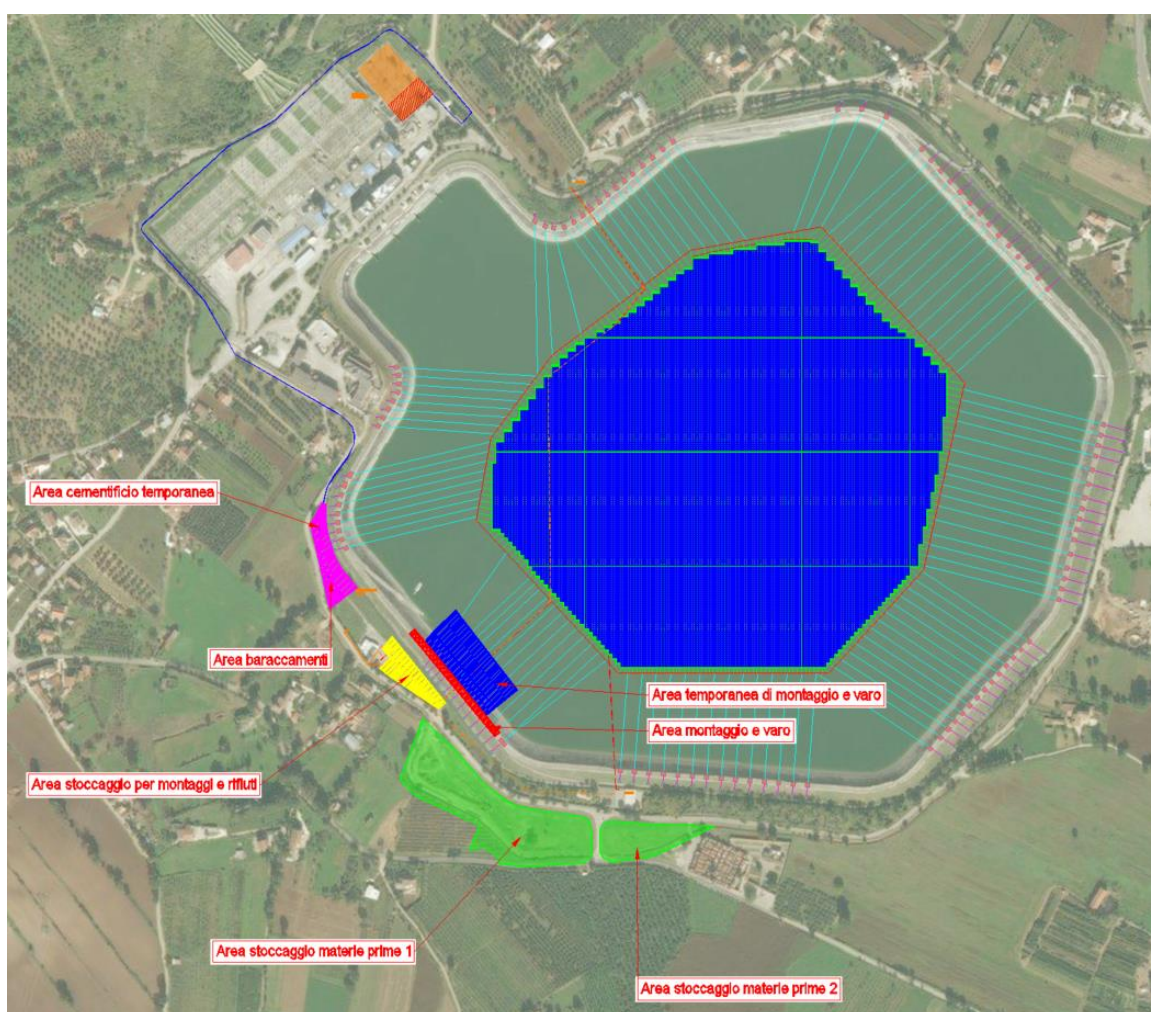
Figura 6-12: Aree di cantiere e di installazione
