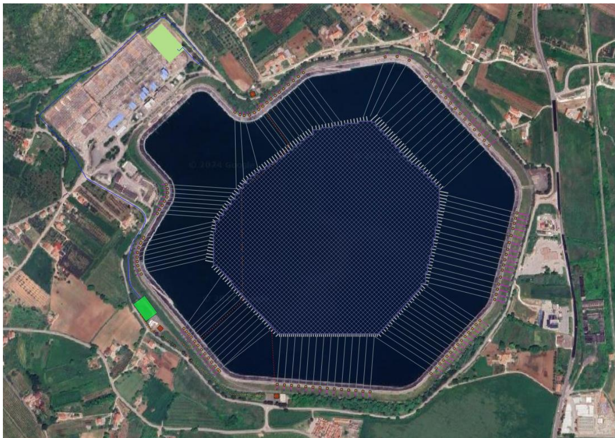
Figure 8-20. La figura mostra il rapporto tra il layout progettuale e la copertura libera da celle fotovoltaiche.
