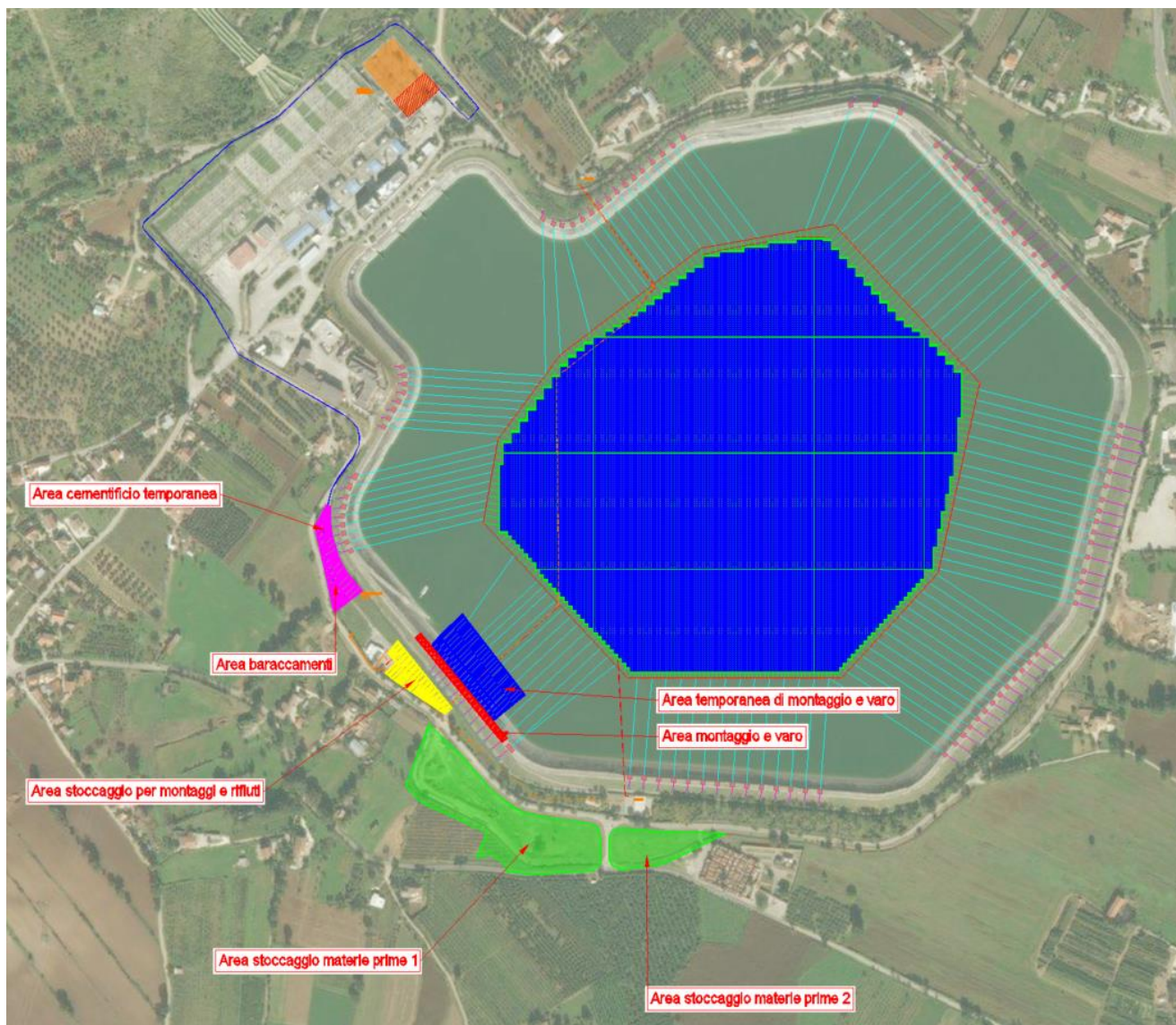
Figura 8-1: Aree di cantiere e di installazione
