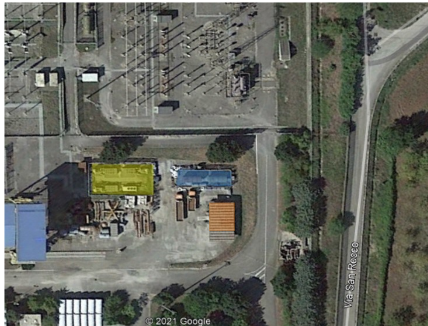
Figura 6-2 - Area di intervento, in azzurro i serbatoi olio e in giallo le UTA. In arancione la Tettoia Fusti olio
