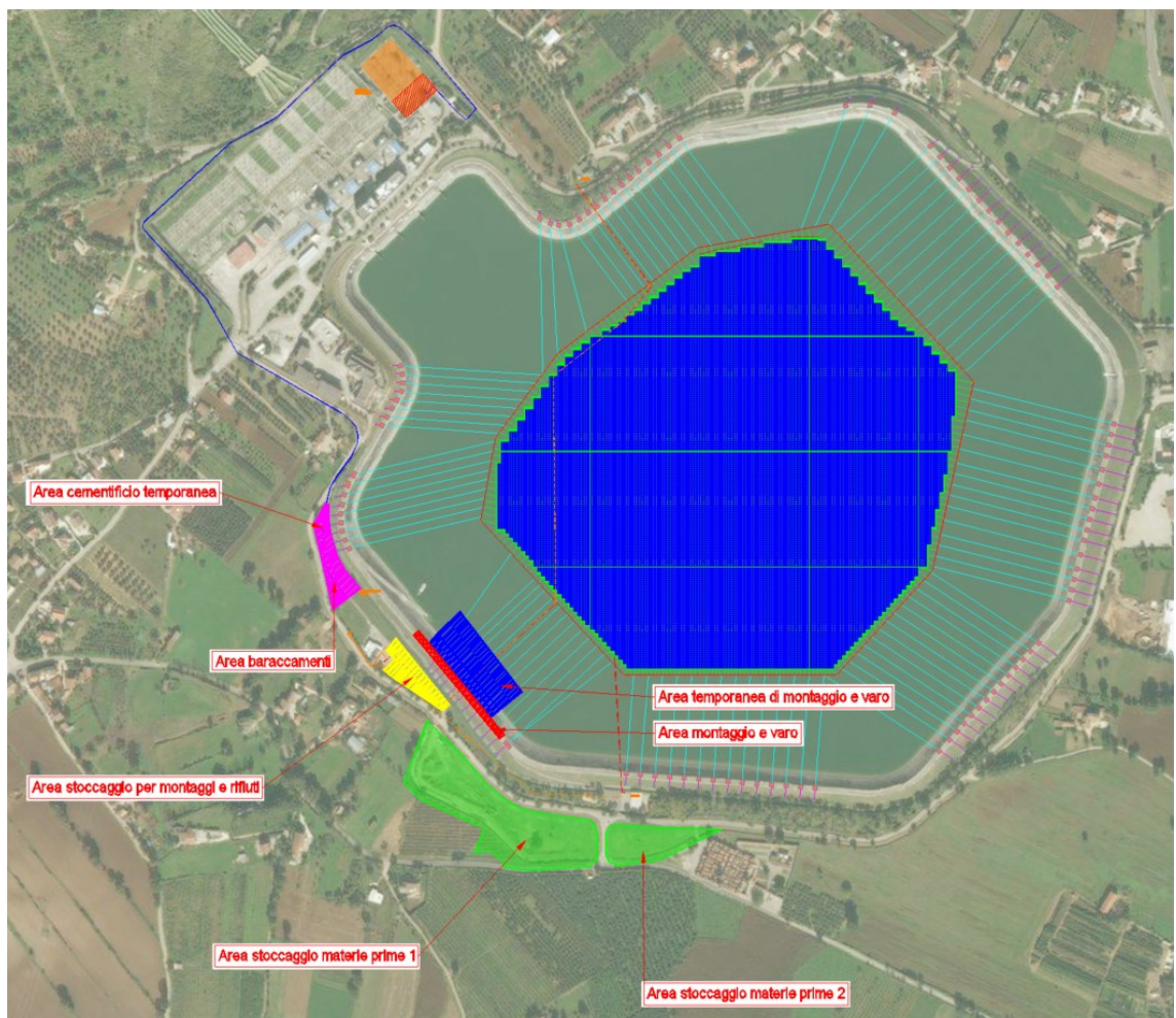
Figura 4-22: Aree di cantiere e di installazione
