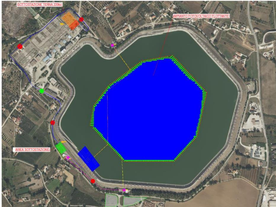
Figura 8 - Ubicazione dei cavidotti su ortofoto (in rosso si riporta l'ubicazione di massima dei punti di prelievo campioni che saranno confrontati con i limiti col. B e in verde i campioni che saranno confrontati con le CSC col. A).
