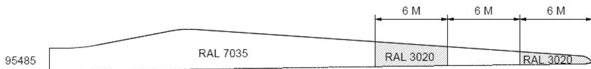
Figura 3 – Schema indicativo colorazione pale (la larghezza effettiva delle bande colorate sarà apposta in accordo con quanto specificato in Tabella 6.1)
