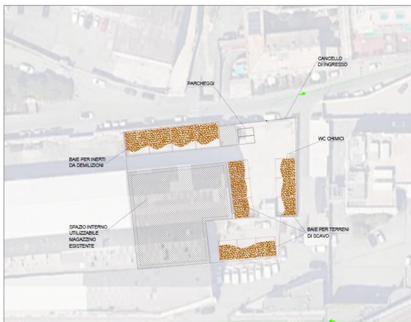
Figura 17 dettaglio aree di stoccaggio
