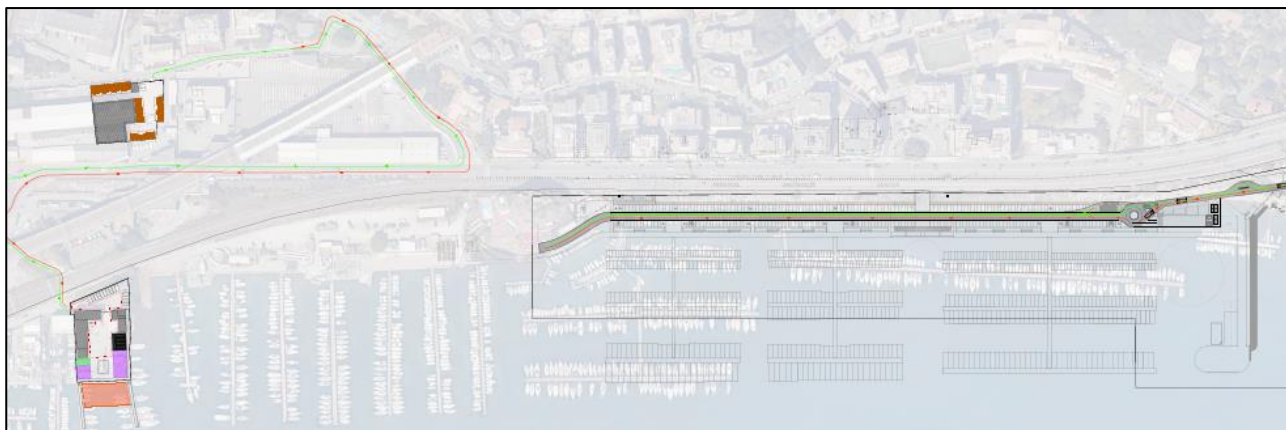
Figura 16 planimetria generale di cantierizzazione
