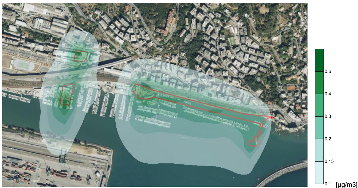
Figura 23 concentrazione media annuale NO2 per la fase di cantiere.
