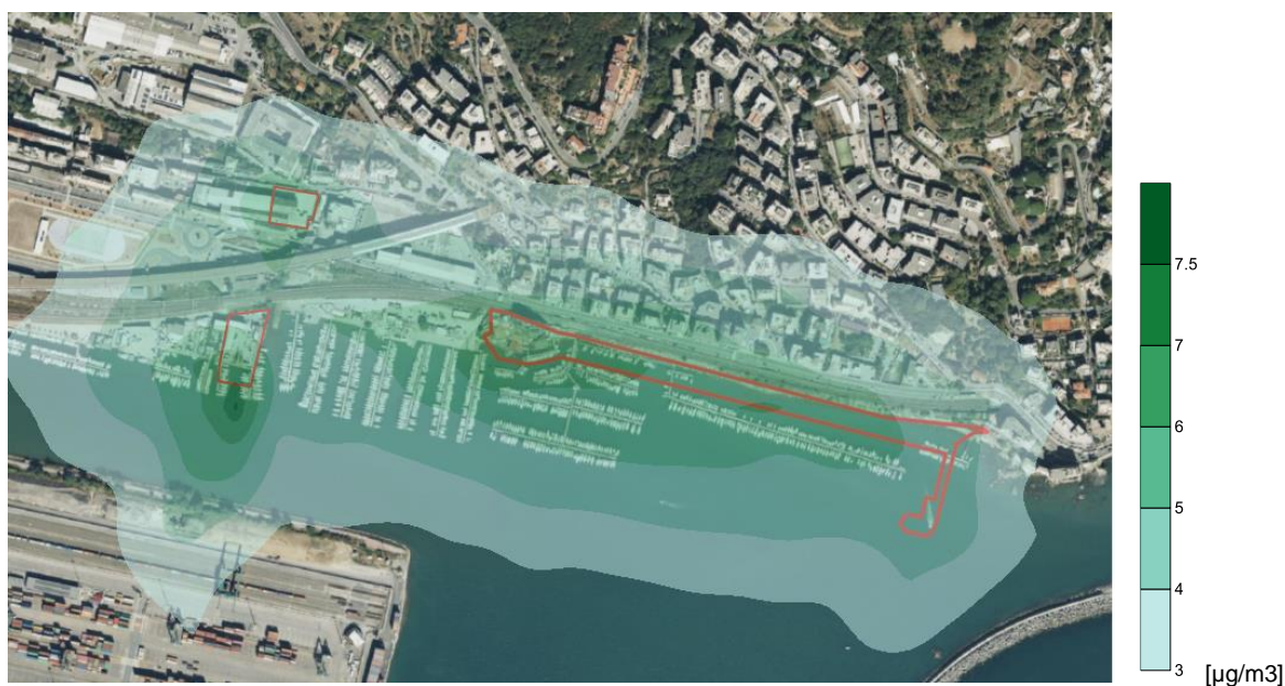
Figura 24 concentrazione percentile 99.8° media oraria NO2 per la fase di cantiere.
