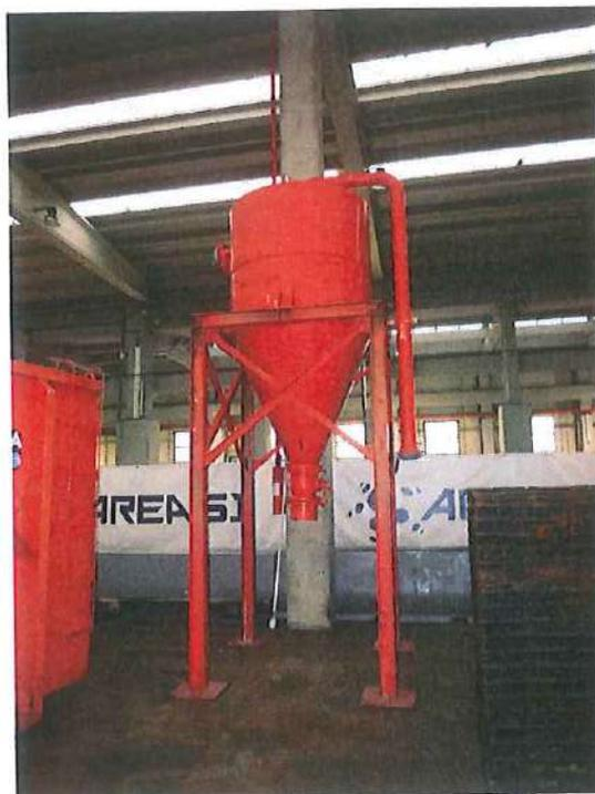
**-tramoggia di scarico dotata di cannocchiale per scarico diretto in big bag**
