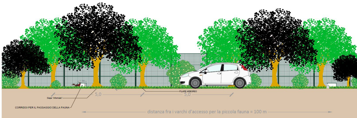
Figura 10 - Particolare delle aperture nelle recinzioni
