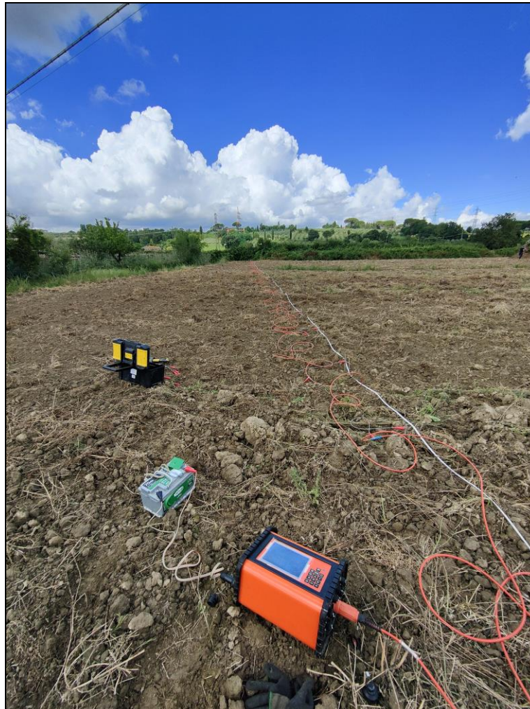
Figura 2-a: Esecuzione indagine geoelettrica
