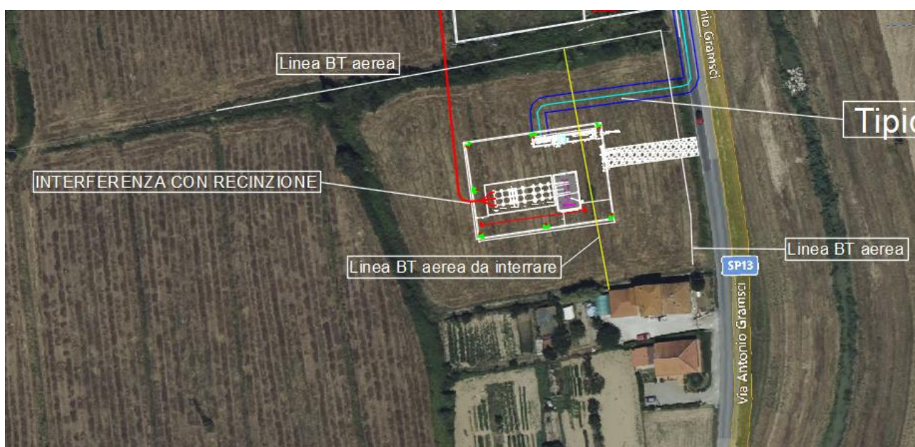
Figura 6a: linea aerea BT interferente con la sottostazione
