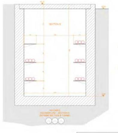
Questa tipologia di posa è assimilabile a quella di una terna di conduttori posati in piano dove ogni fase è composta da due conduttori in parallelo, per i quali la Norma CEI 106-11 prevede l'uso della formula seguente per il calcolo della DPA:
