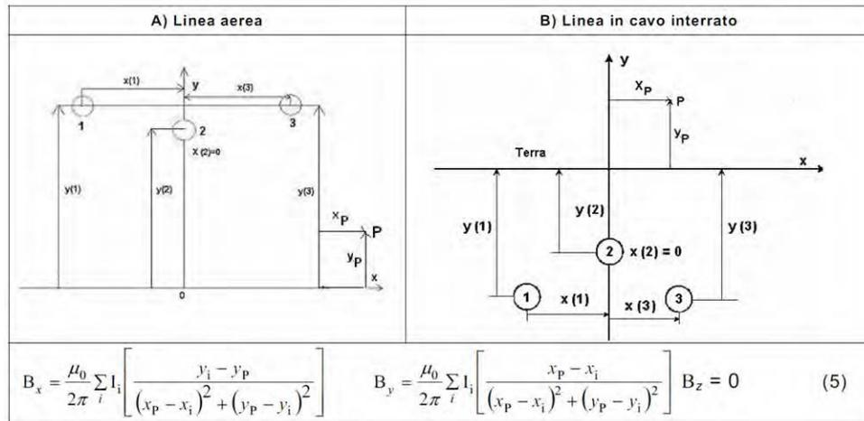
Schematizzazione delle linee aeree e in cavo interrato e formule per la determinazione dei fasori delle componenti spaziali dell'induzione magnetica
