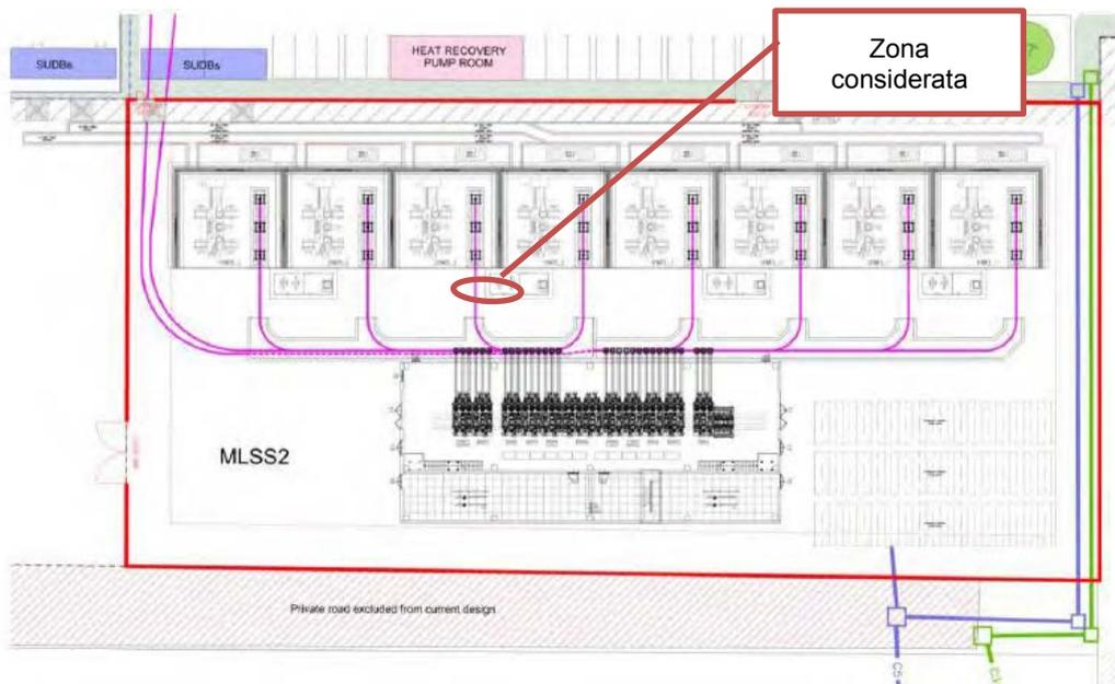
Questa tipologia di posa è assimilabile a quella di una terna di conduttori posati in piano, per i quali la Norma CEI 106-11 prevede l'uso della formula seguente per il calcolo della DPA:
