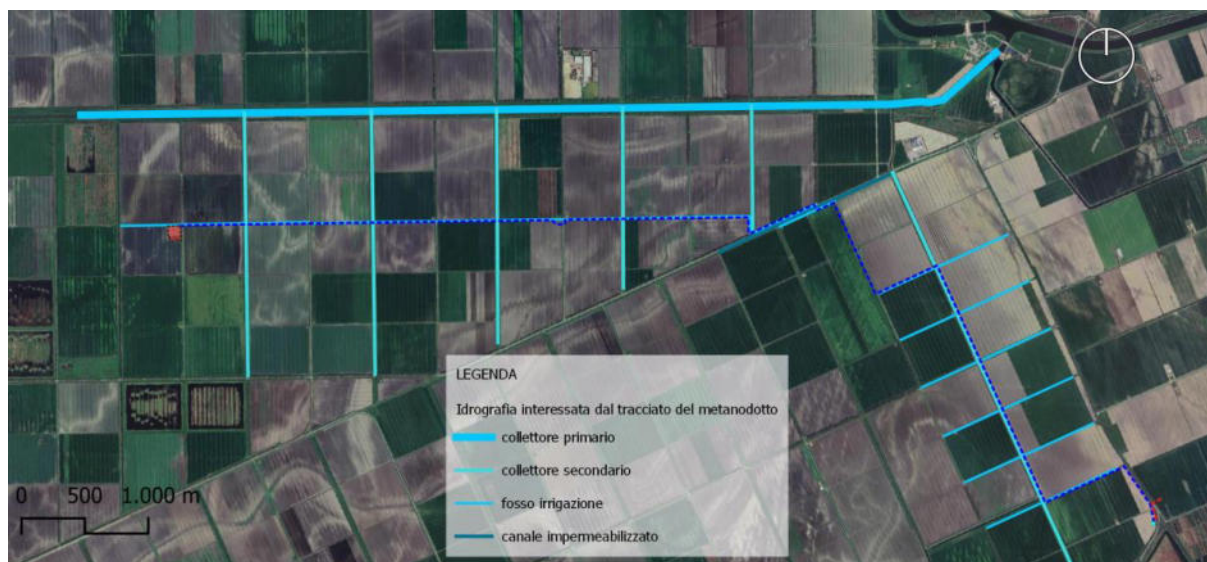
Figura 4.57. Idrografia nell'area del tracciato del metanodotto. La carta mostra solamente i canali direttamente interessati dal transetto (escluso il collettore Mozzano "collettore primario"), non sono mostrati i canali di irrigazione interni ai campi.
