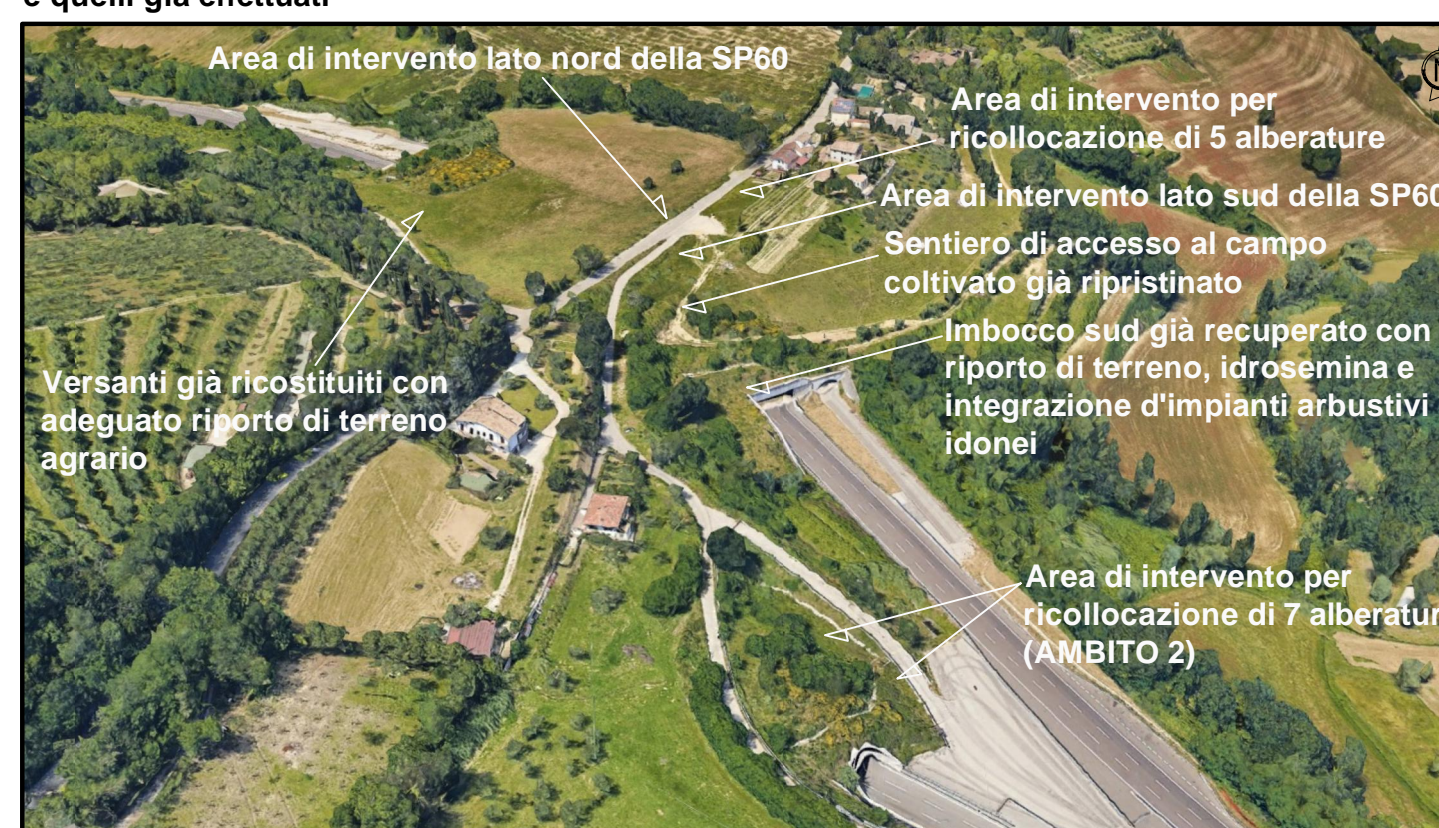
Vista generale prospettica stato esistente anno 2020 con indicati gli interventi previsti e quelli già effettuati
