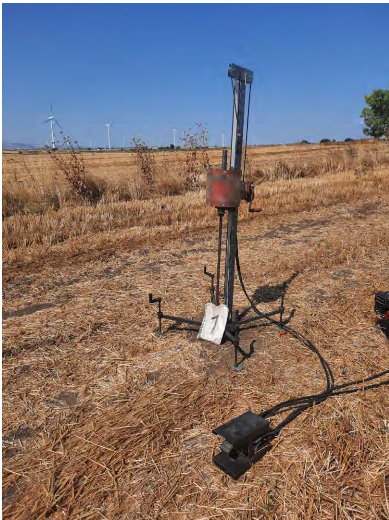
Figura 17 - Realizzazione della prova penetrometrica PP1
