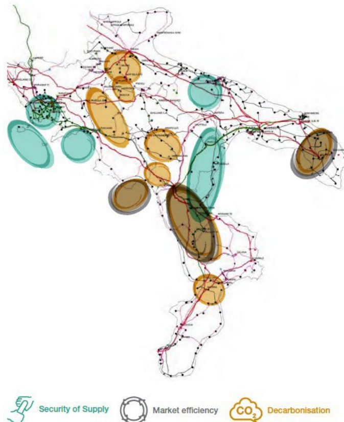
Figura 1: principali criticità della rete elettrica nelle regioni Puglia, Campania, Calabria e Basilicata
