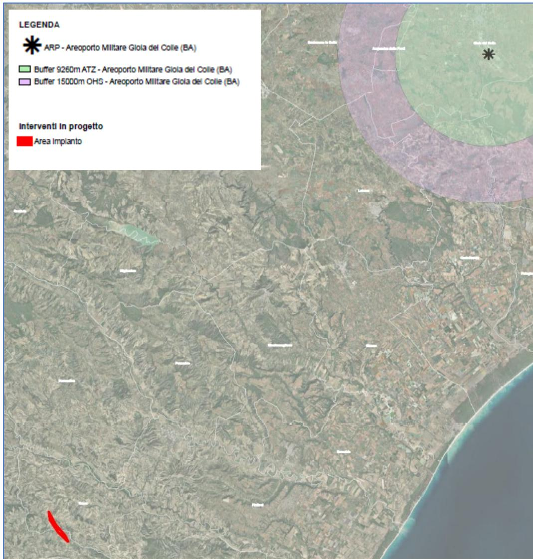
Figura 41 – Interferenze con le infrastrutture di volo stralcio tavola CRC\_AMB\_TAV\_053\_01
