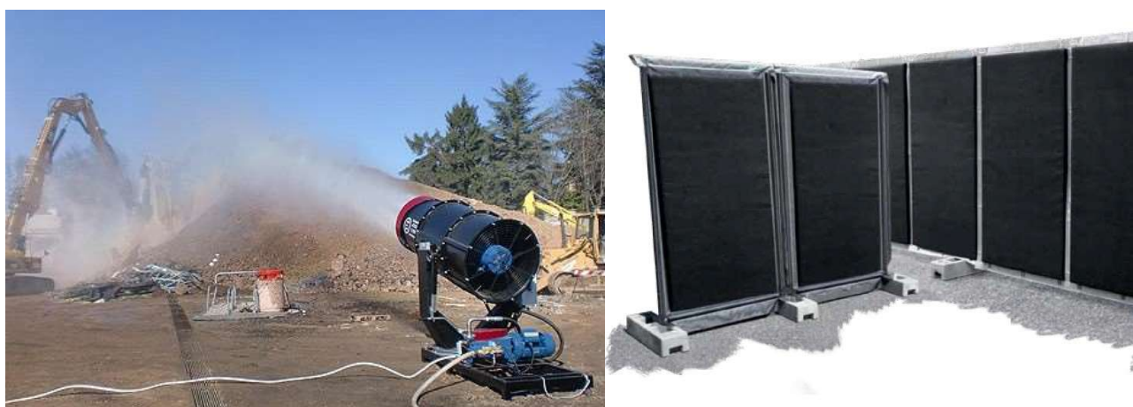
Figura 19: Esempi di misure di mitigazione (nebulizzatore fog cannon e barriere antirumore)
