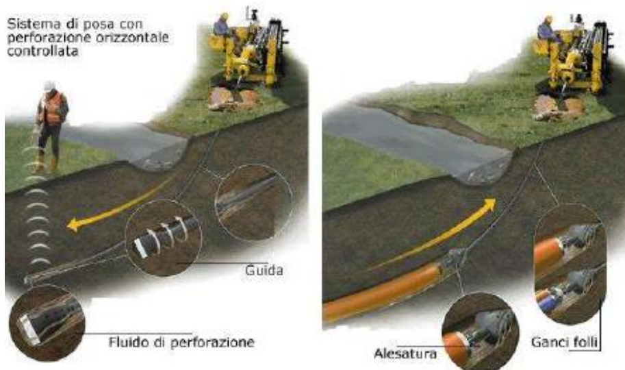
Figura 35: Posa in opera tubazione con trivellazione teleguidata
