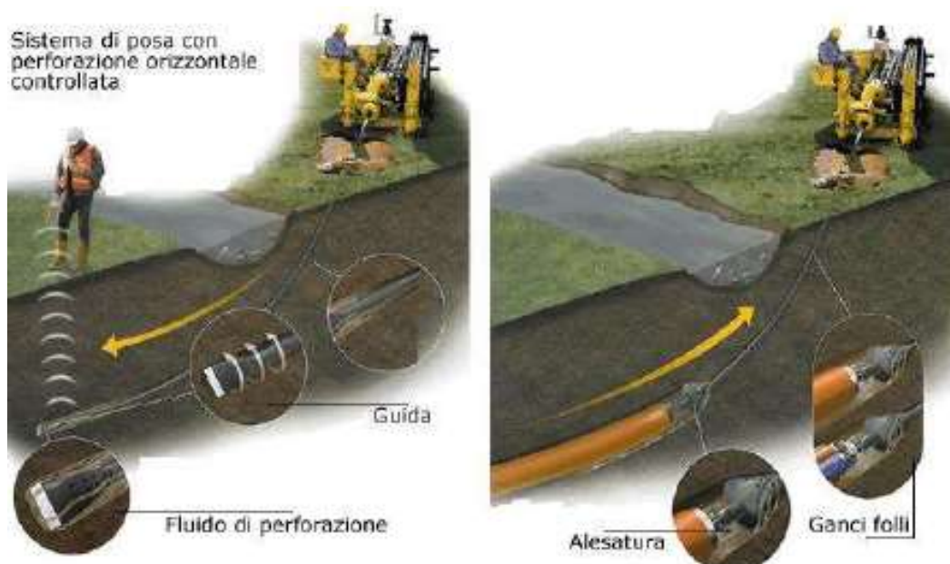
Posa in opera tubazione con trivellazione teleguidata
