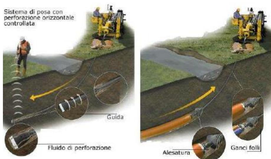
Figura 4: Posa in opera tubazione con trivellazione teleguidata
