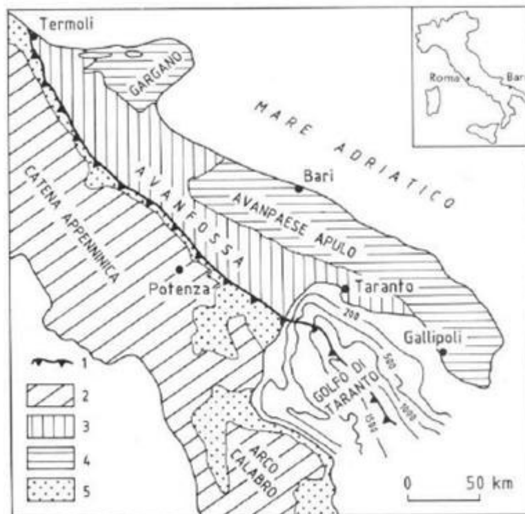
Figura 4.1: Schema dei principali domini geodinamici: 1) Limite delle Unità Appenniniche Alloctone; 2) Catena Appenninica ed Arco Calabro; 3) Avanfossa; 4) Avampaese Apulo-Garganico; 5) Bacini Plio-Pleistocenici – Fonte: Zezza et al., 1984).
