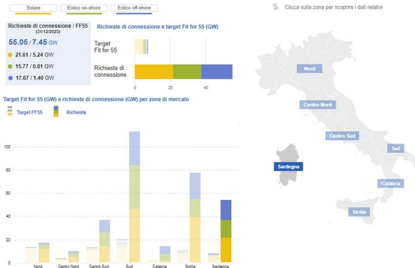
Figura 3- (elaborazione Terna S.p.A. per il Target FIT FOR 55 al 2030 in Sardegna al 31/12/2023, con evidenziata una richiesta di connessione alla RTN per 55 GW rispetto ai 7,45 GW preventivati come necessari per il predetto target)
