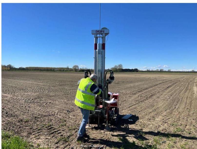
Figura 10 - Documentazione fotografica prove penetrometriche – DPSH2.
