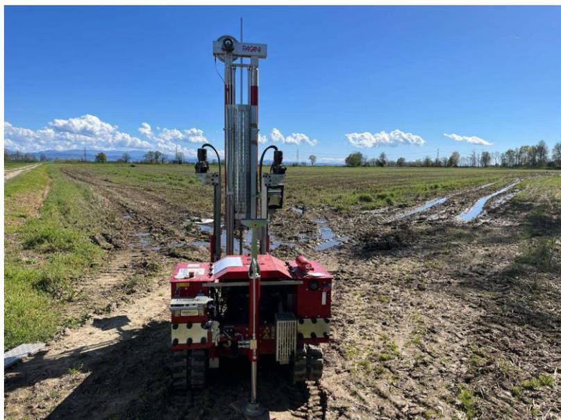
Figura 11 - Documentazione fotografica prove penetrometriche – DPSH3.
