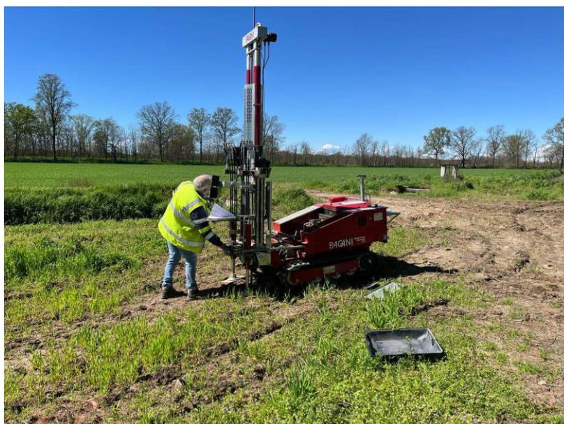
Figura 9 – Documentazione fotografica prove penetrometriche – DPSH1.
