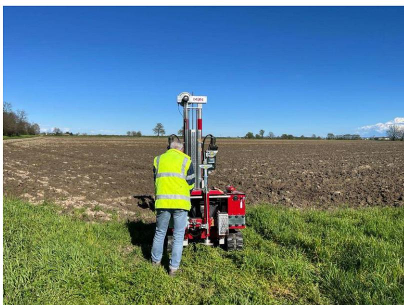
Figura 12 - Documentazione fotografica prove penetrometriche – DPSH4.
