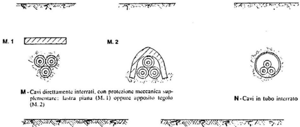
Figura 2 - Modalità posa cavi interrati (figura 3.6 CEI 11-17)
