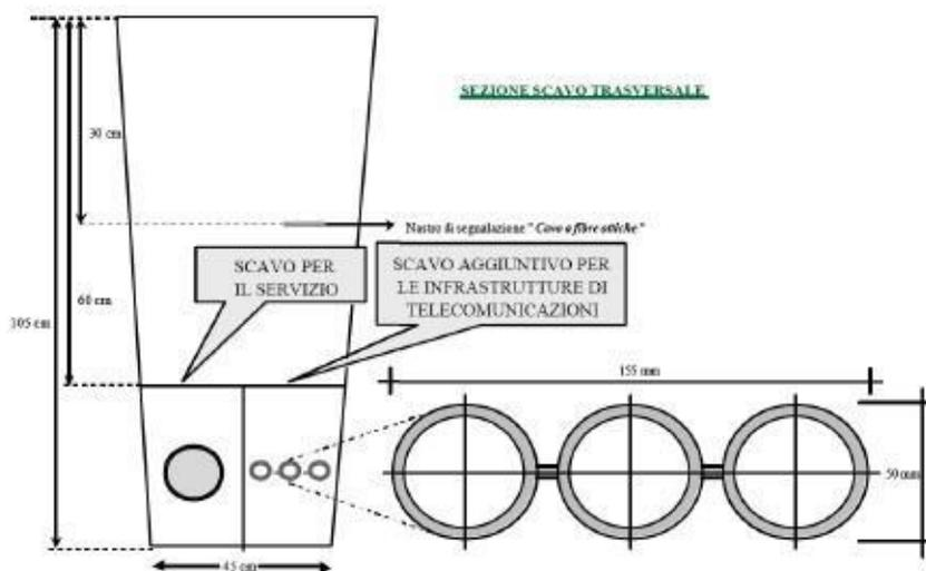
*Figura 5 - Sezione tipo per posa tritungolo*
