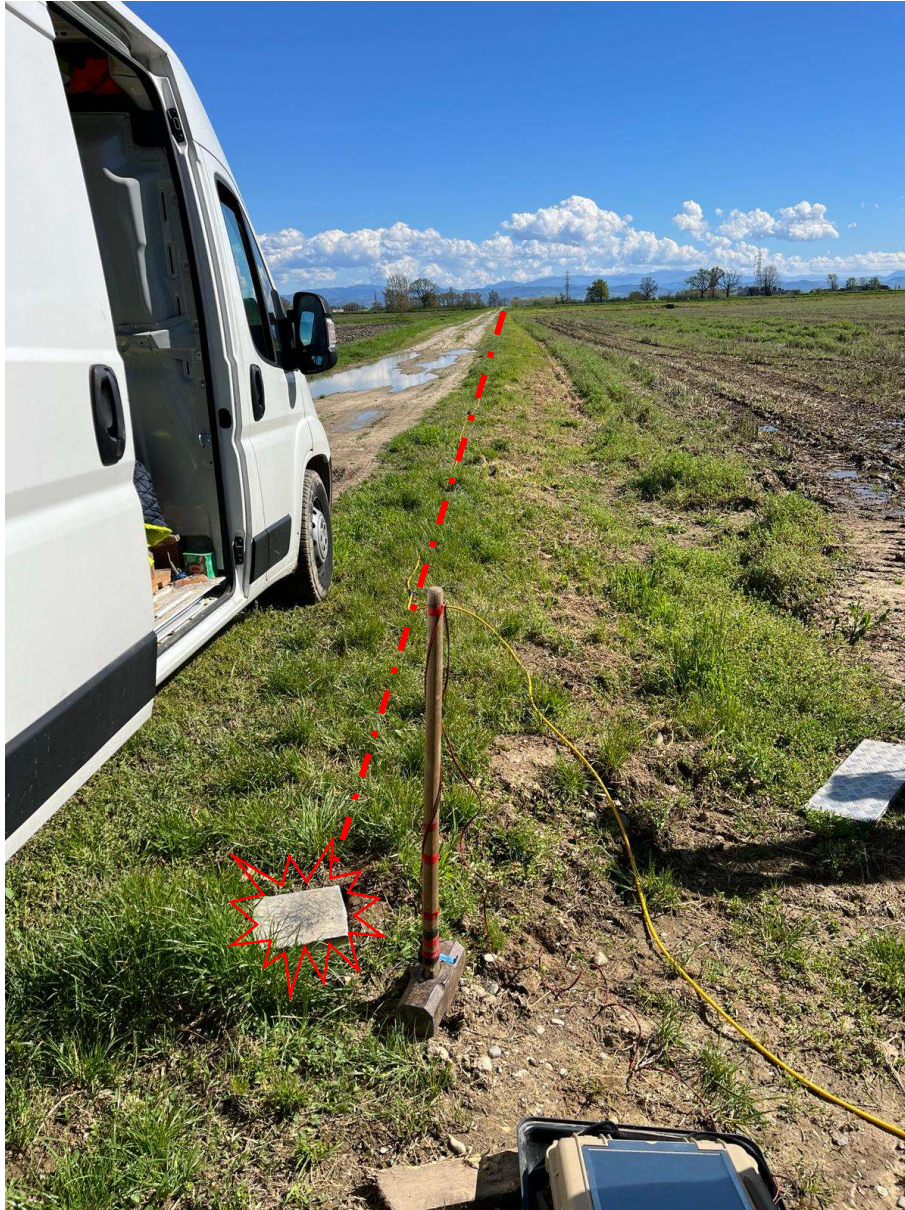
Foto 1 – Ubicazione base sismica “L1” e relativo punto di energizzazione
