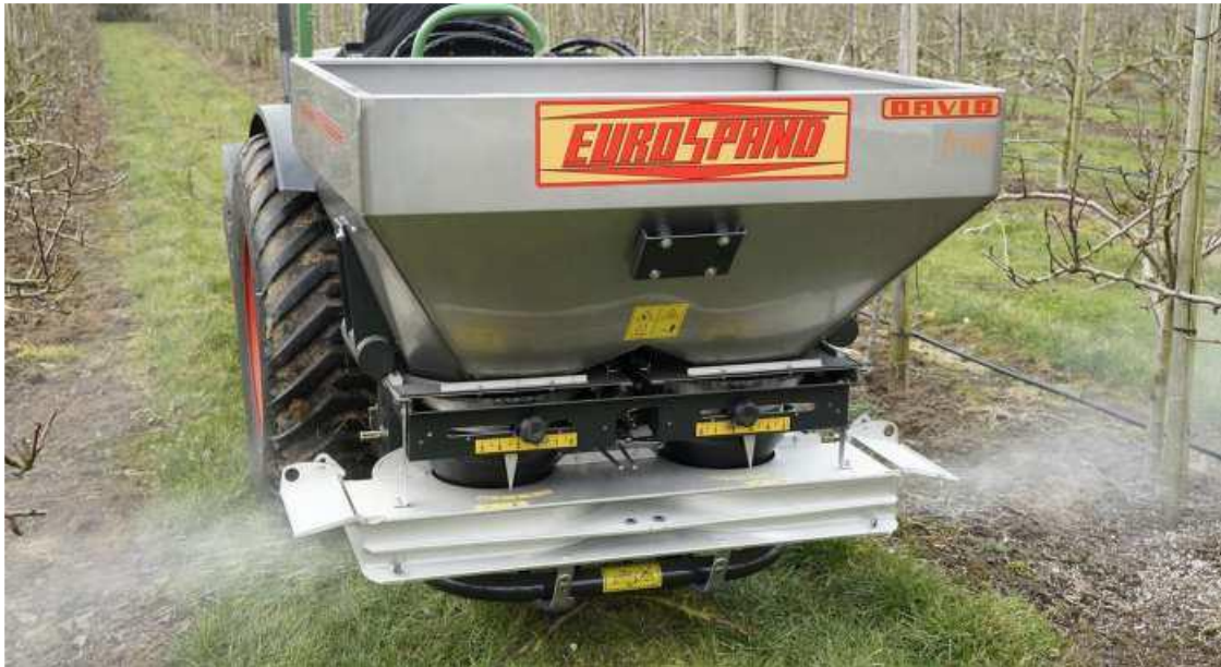
Figura 48-49: Esempio di spandiconcime localizzato mono/bilaterale per frutteti
