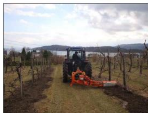
Figura 38: Esempio di fresatrice interceppo per le lavorazioni sulla fila
