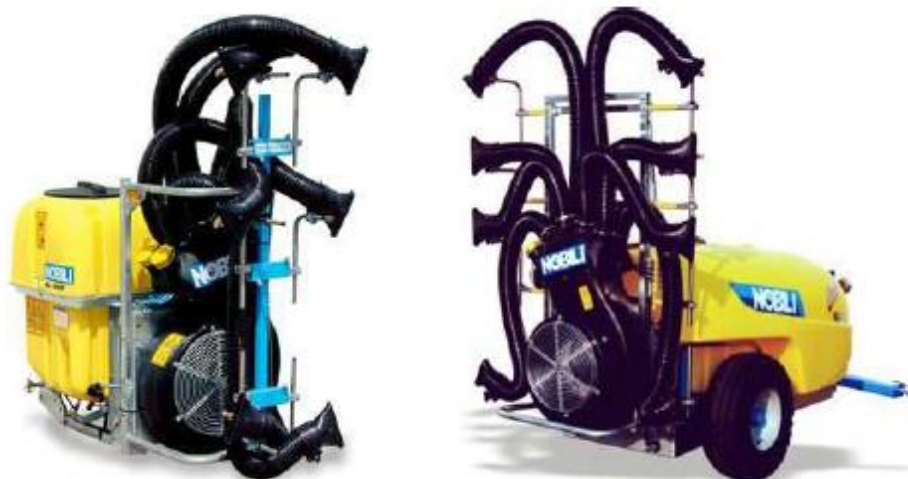
Figura 50: Esempio di atomizzatore per frutteti
