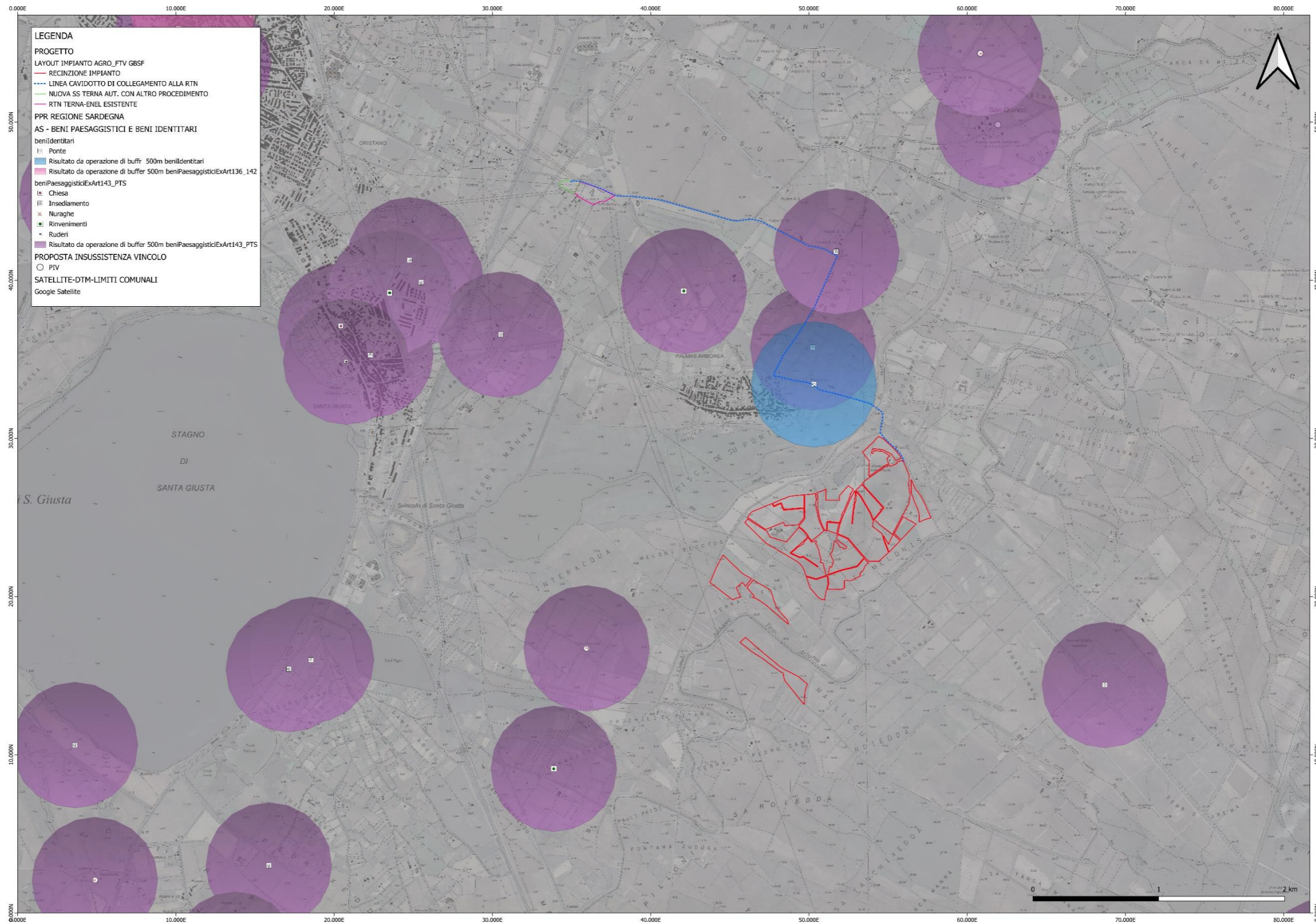
Figura 24: Inquadramento Impianto Agrofotovoltaico con DISTANZE RISPETTO 500 M DAI BENI SOTTOPOSTI A TUTELA. L'area di impianto agrofotovoltaico come rappresentato nell'immagine non ricade nel buffer dei 500 m dei beni identitari e paesaggistici (beniPaesaggisticiExArt136_142, beniPaesaggisticiExArt143_PTS, beniPaesaggisticiExArt143_PLG)
