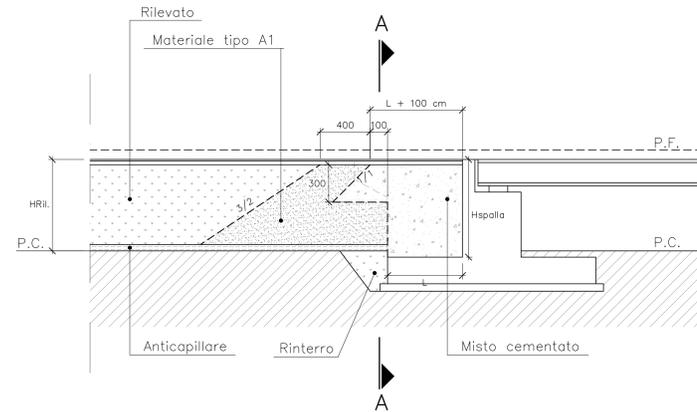
SEZIONE SCHEMATICA DEL CORPO STRADALE
