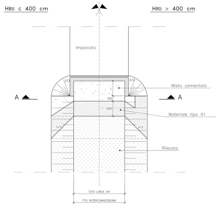
ZONA DI TRANSIZIONE RILEVATO/VIADOTTO
