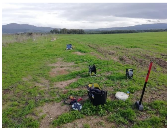
Figura 11.12: Esecuzione prova MASW 2 + rifrazione
