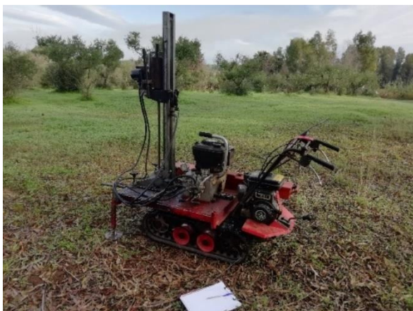
Figura 11.2: Esecuzione prova DIN 1
