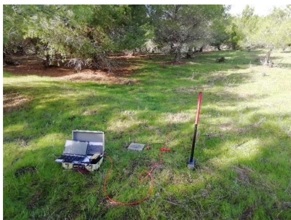
Figura 11.11: Esecuzione prova MASW 1
