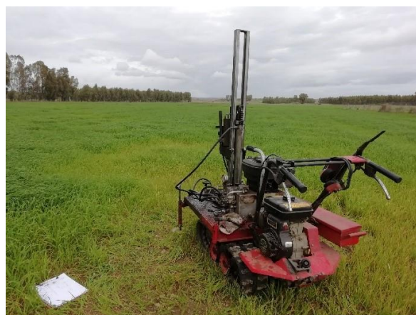
Figura 11.5: Esecuzione prova DIN 4
