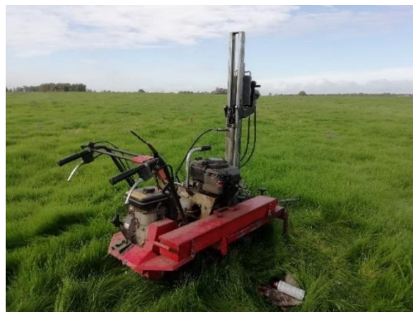
Figura 11.3: Esecuzione prova DIN 2
