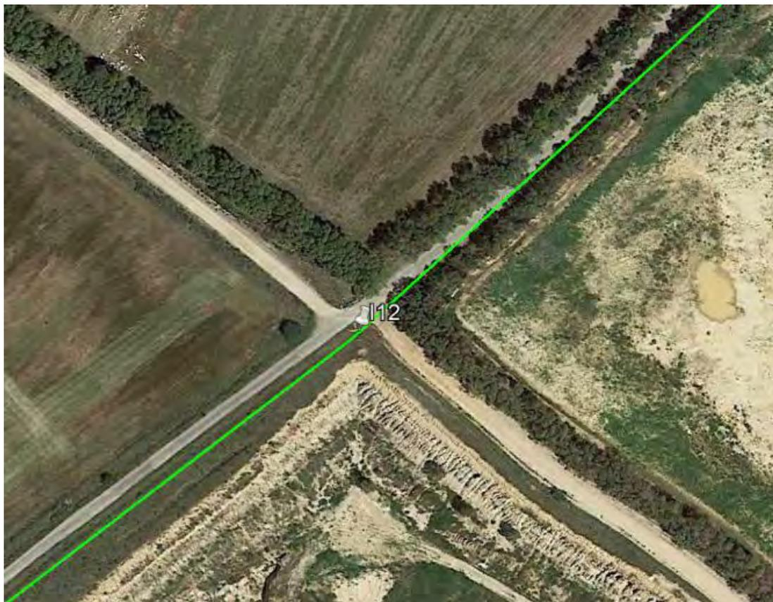
Figura 8.27: Ubicazione su ortofoto dell'interferenza I12, in verde il tracciato del cavidotto di connessione
