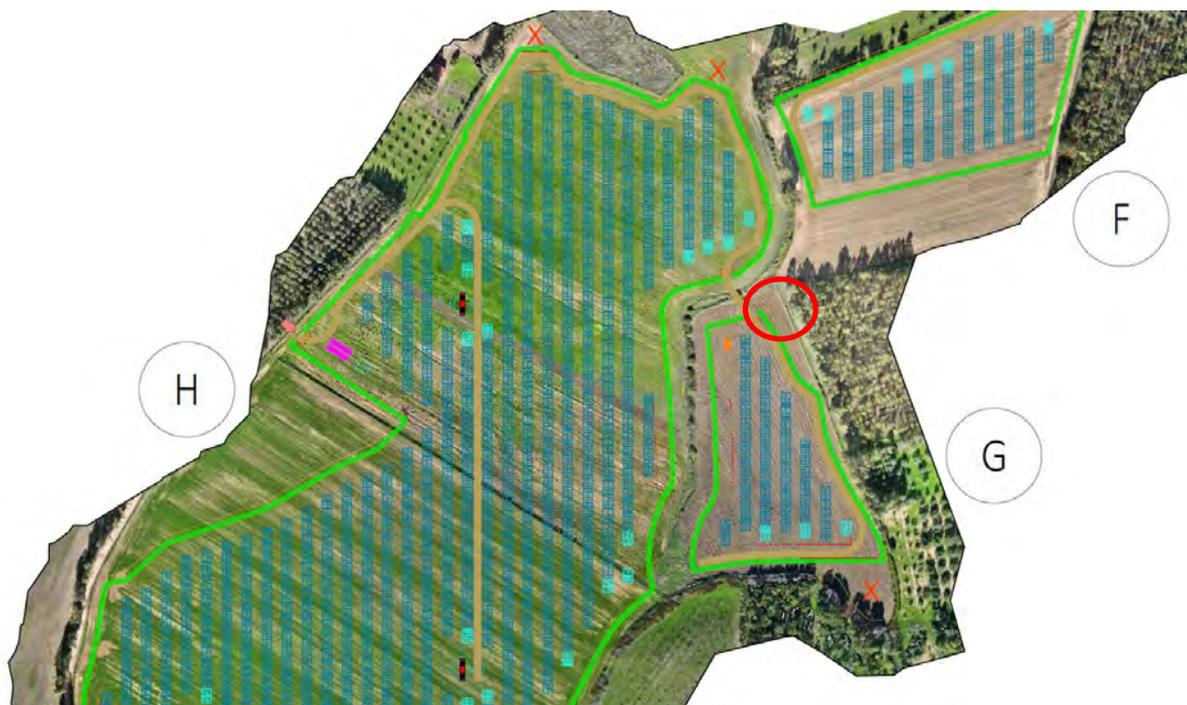
Figura 8.33: Stralcio layout di impianto in corrispondenza dell'interferenza tra viabilità di servizio e reticolo idrografico
