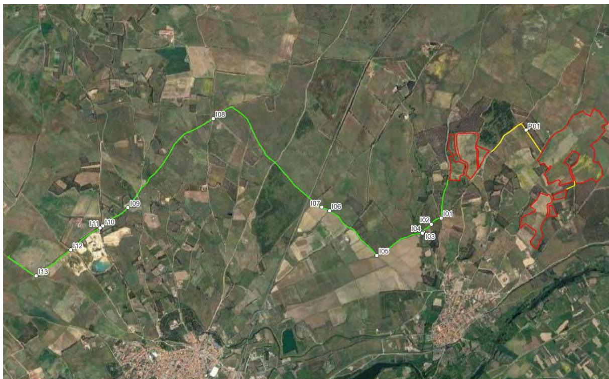
Figura 8.1: Interferenze con l'idrografia lungo il tracciato della linea di connessione (in verde) e lungo la linea di interconnessione tra i lotti (in giallo)
