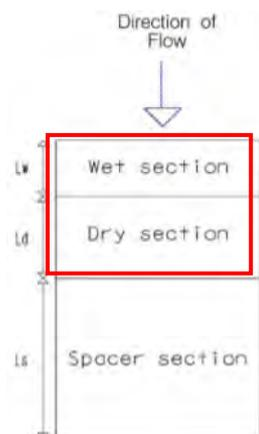
Figura 6.7: Modulo tipo, descrivente il modello concettuale idrologico dell'installazione di strutture fotovoltaiche a tracker su pali infissi comprendente l'area pannelli (in rosso) e l'area di interfila (Fonte: Hydrologic response of solar farm Cook 2013 American Society of Civil Engineers)
