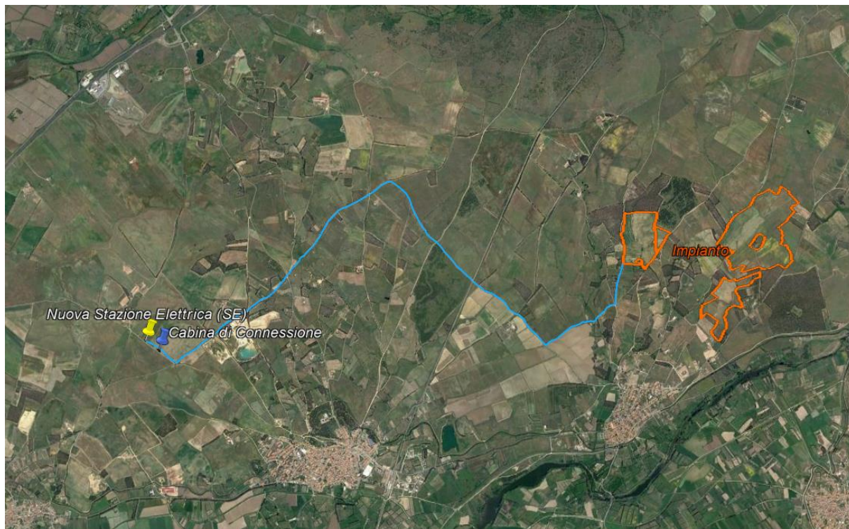
Figura 4.27: Tracciato di connessione alla RTN
