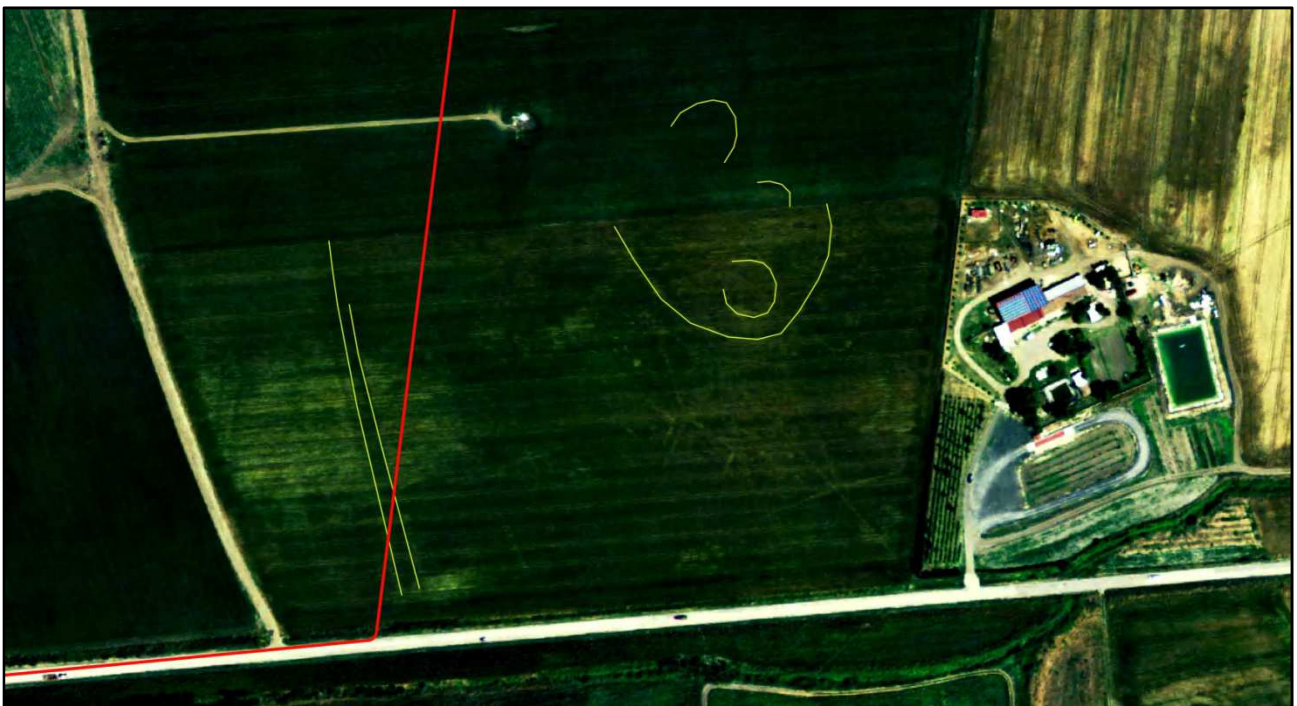
Fig. 17: Restituzione grafica delle anomalie aerofotografiche (in giallo) individuate in località San Martino con indicazione delle opere in progetto (cavidotto in rosso) su base ortofoto 2013 (scala 1:2.500).
