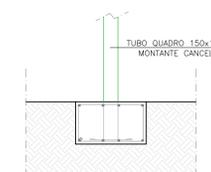
Dettaglio recinzione perimetrale tipo (prospetto)
