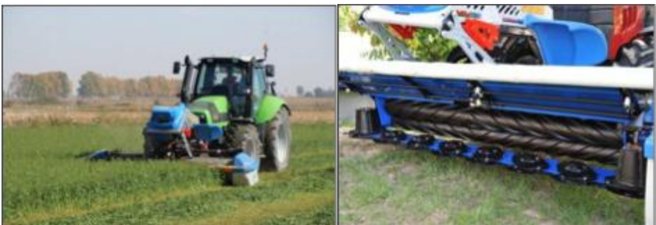
Figura 17: Esempio di falciacondizionatrice frontale e particolare dei rulli in gomma.
