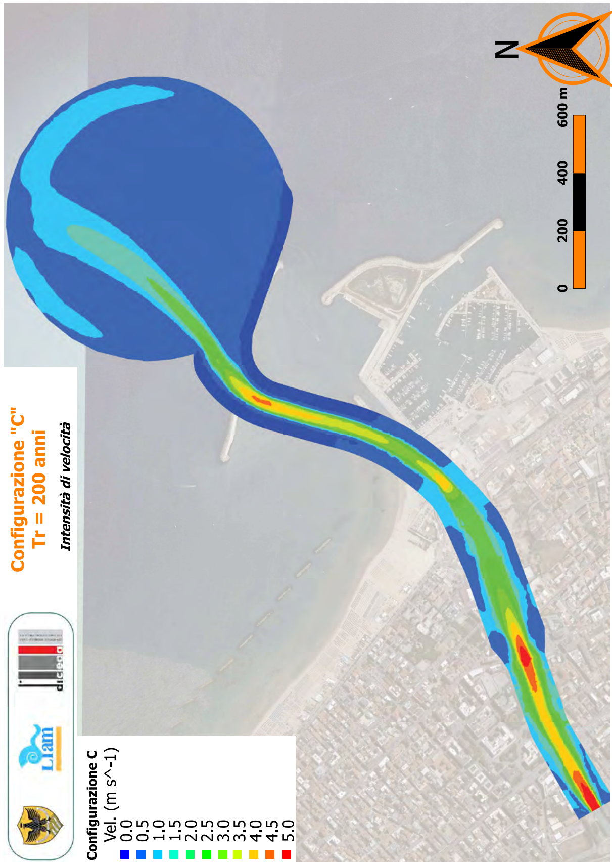
Figura A-27: Configurazione C. Distribuzione spaziale dell'intensità di velocità ( T_R = 200 anni).
