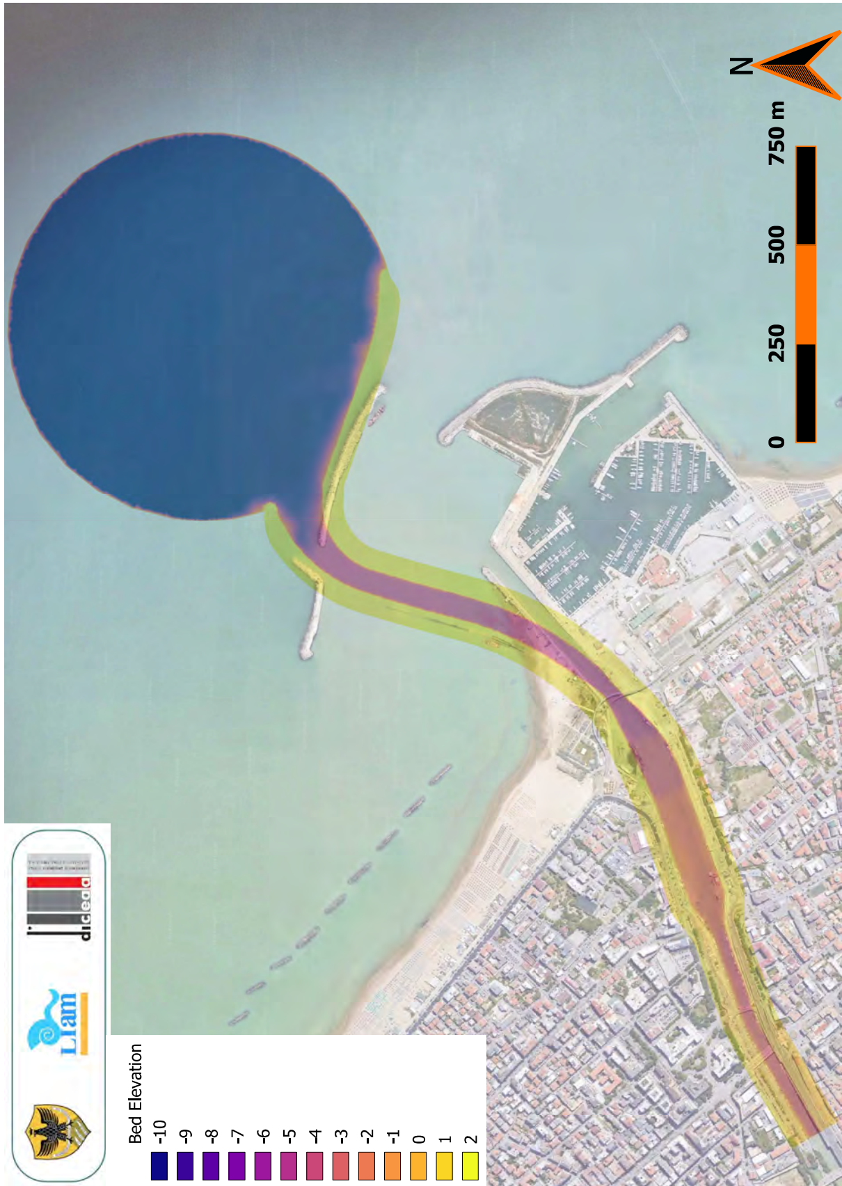
Figura 3-7: Configurazione "C". Distribuzione batimetrica ( bed elevation , m lmm).
