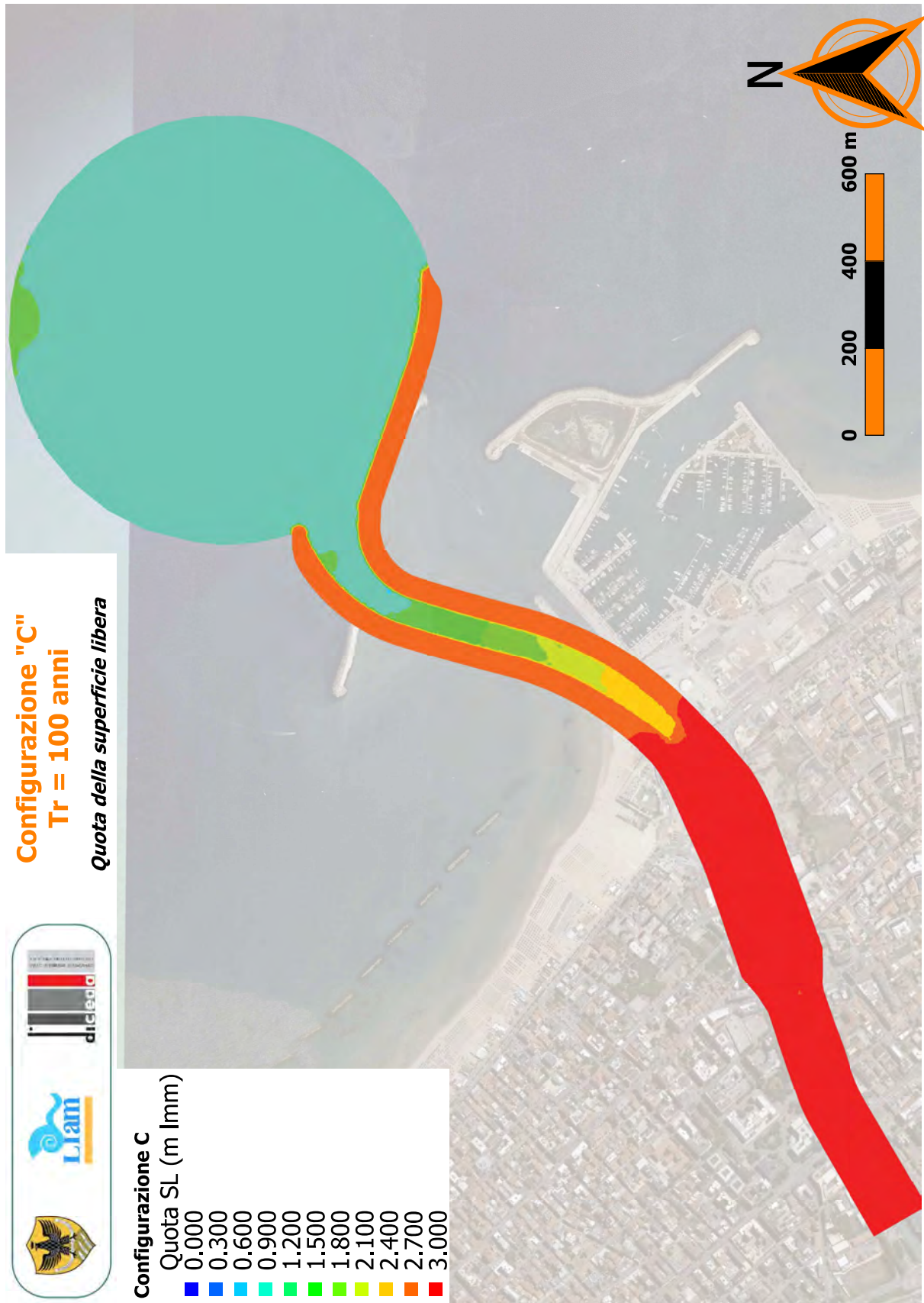
Figura A-51: Configurazione C. Quota raggiunta dalla superficie libera ( T_R = 100 anni).
