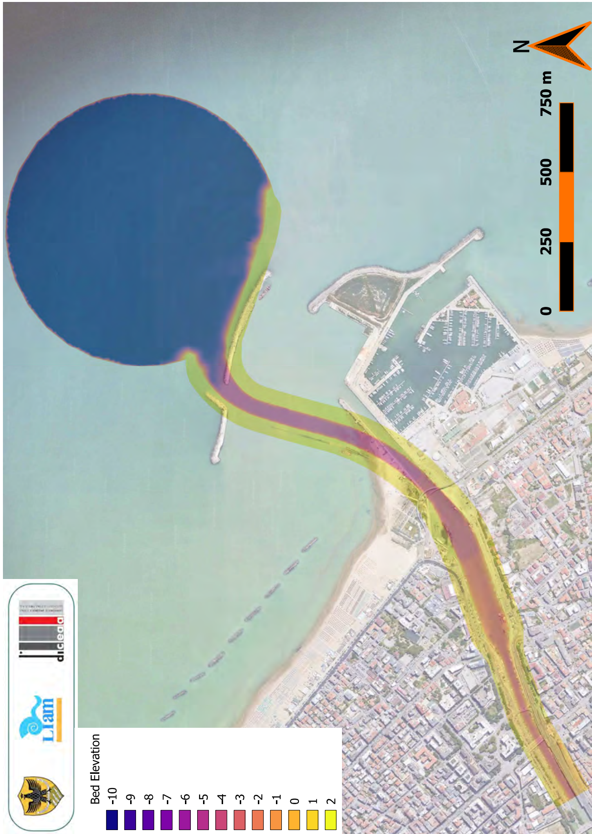
Figura 3-5: Configurazione "PRP2008". Distribuzione batimetrica ( bed elevation , m lmm).
