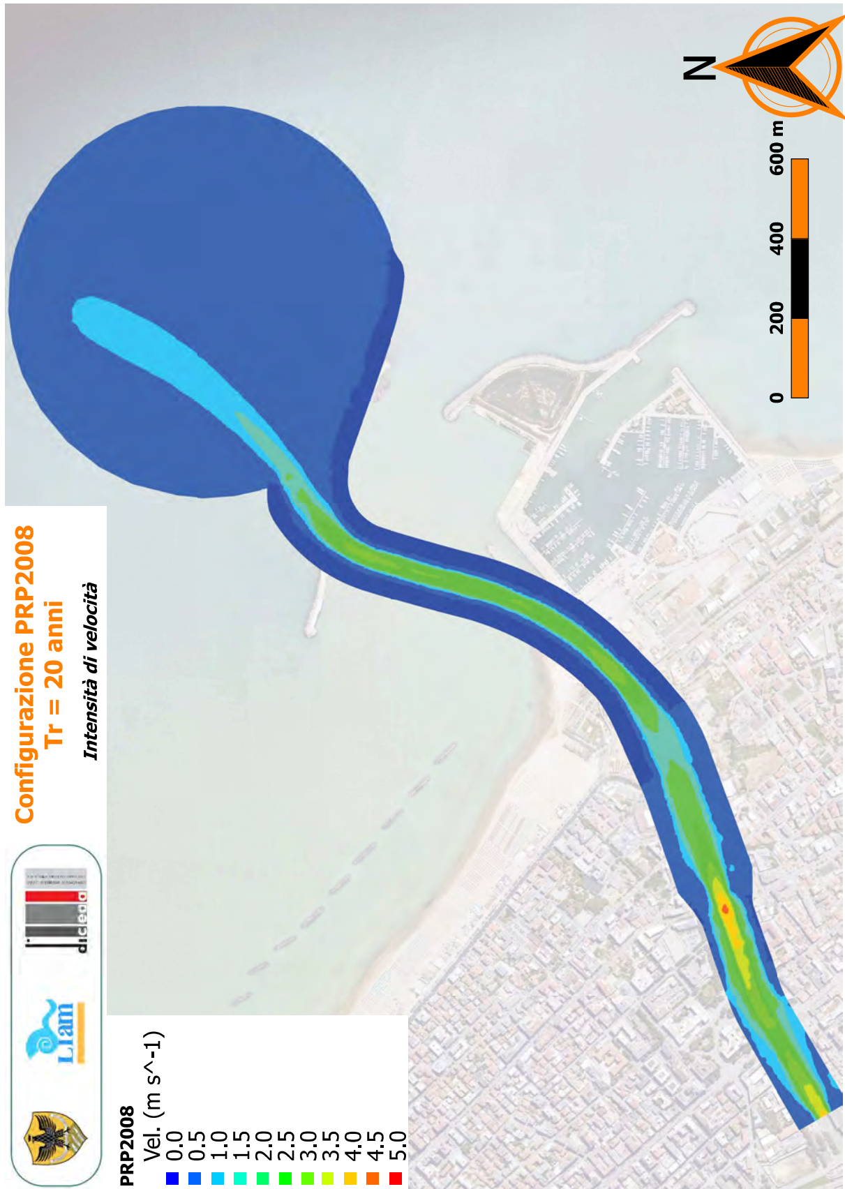
Figura A-7: Configurazione PRP2008. Distribuzione spaziale dell'intensità di velocità ( T_R = 20 anni).
