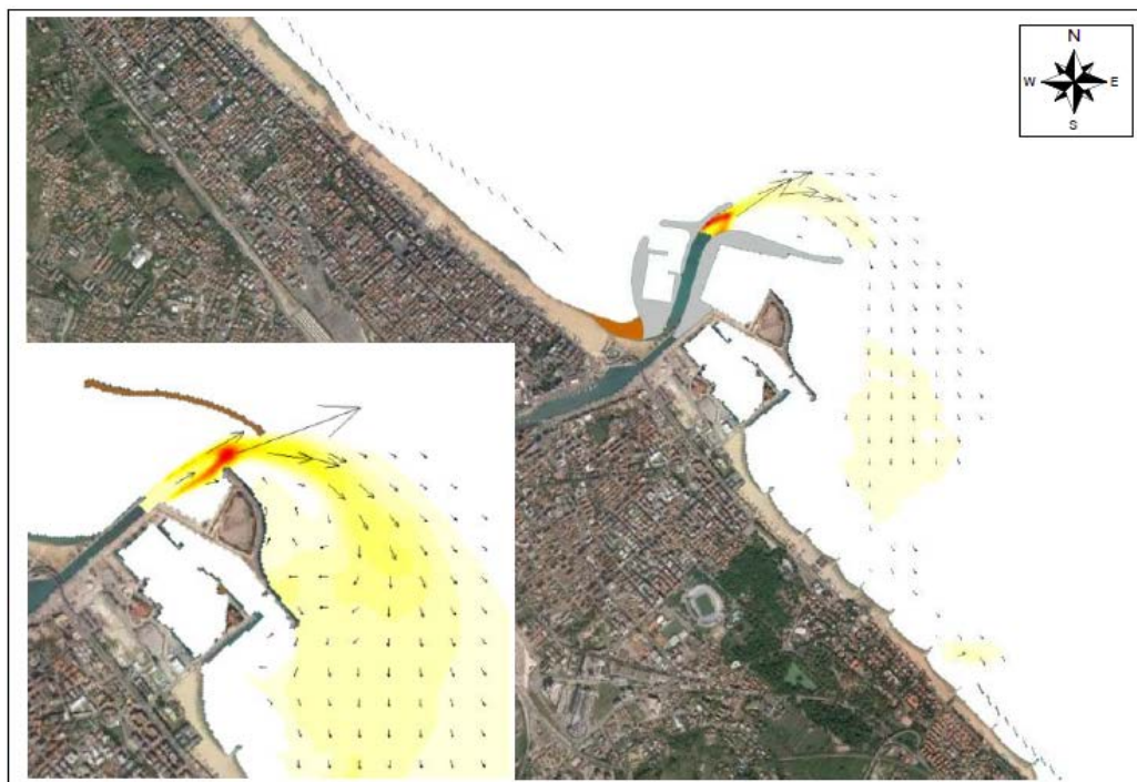
Figura 4-35 - TEST 5P - Tramontana 1 g/anno con piena T_r = 25 anni – Trasporto solido con D50 pari a 0.25 mm (Fonte Beta Studio, 2016).
