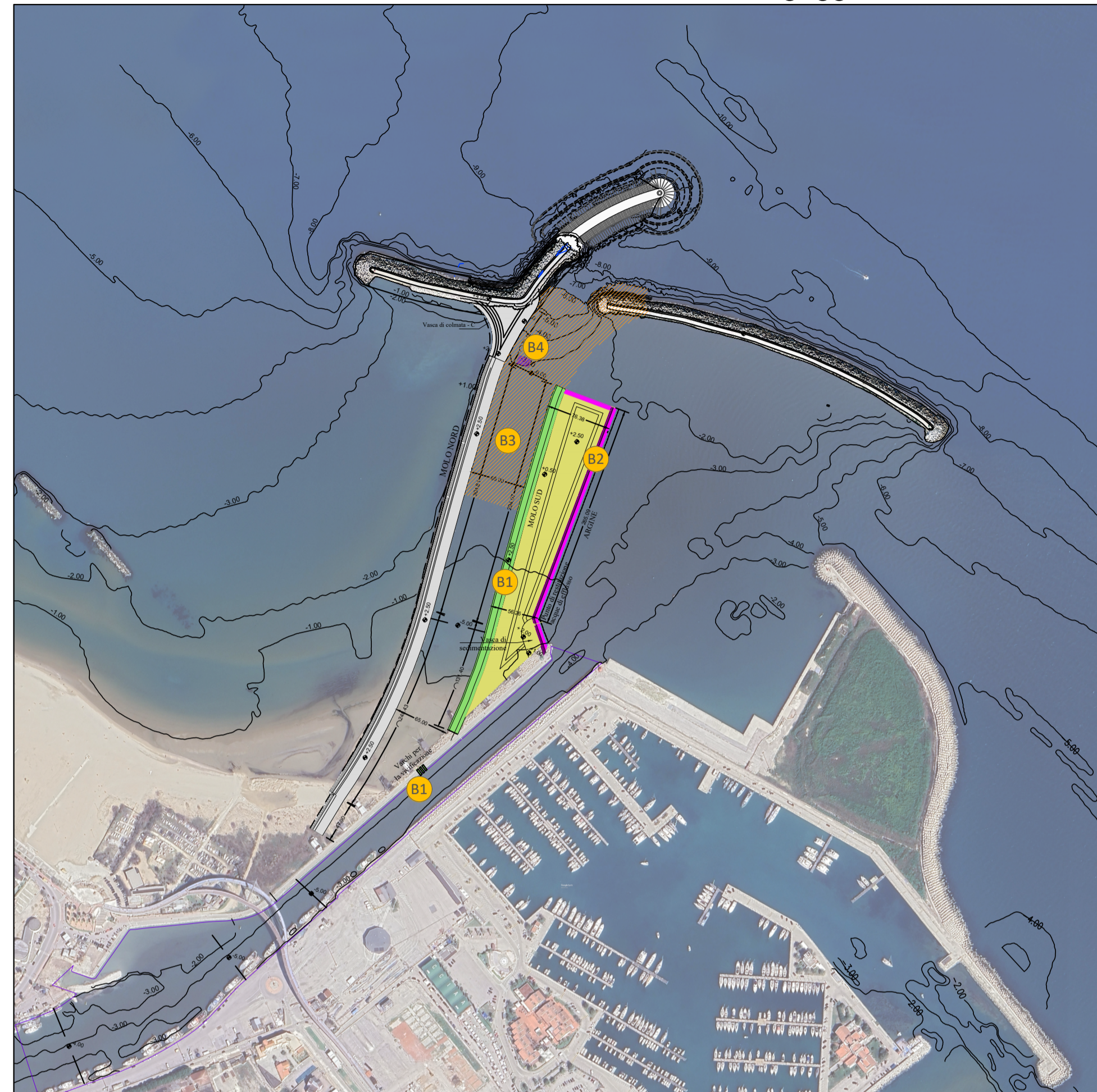
FASE B - Molo Sud, Vasca colmata A e dragaggio fase 1
