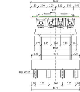
SEZIONE TRASVERSALE TIPO 50M - MISTO - 12 PALI
