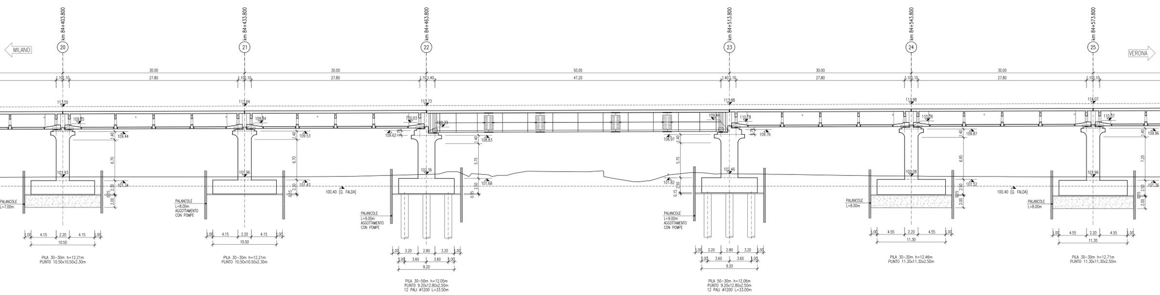
SEZIONE TRASVERSALE TIPO 30M - C.A.P. - DIRETTA
