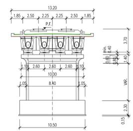
SEZIONE TRASVERSALE TIPO 30M - C.A.P. - DIRETTA
