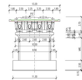
SEZIONE TRASVERSALE TIPO 30M - C.A.P. 12 PALI (pile "P22"-"P23")
