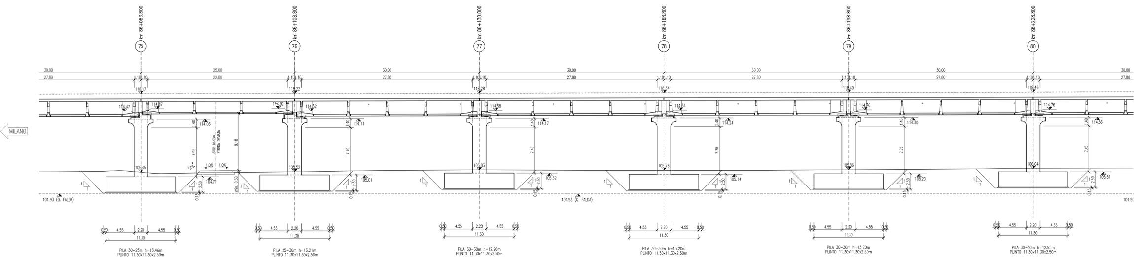
SEZIONE TRASVERSALE TIPO 30M - C.A.P. - DIRETTA
