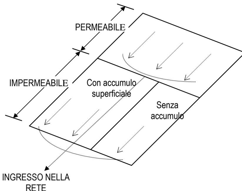
Con tale schematizzazione si ha un sistema tra l'equazione di continuità e l'equazione del moto, rappresentata dall'equazione di Manning. Lo schema a cui viene fatto riferimento per il calcolo è il seguente:
