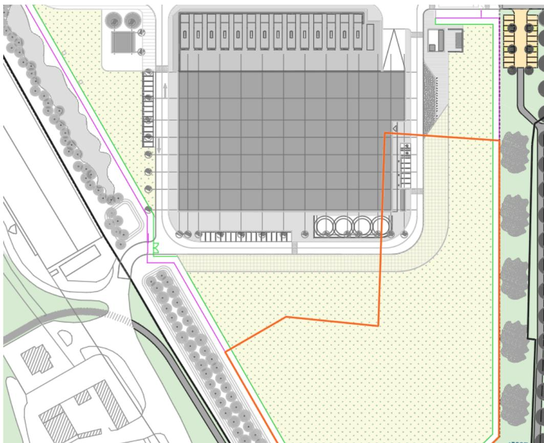
Figura 6 - Layout di progetto (Masterplan) (area cappata ricoperta di terreno vegetale perimetrata in arancione)
