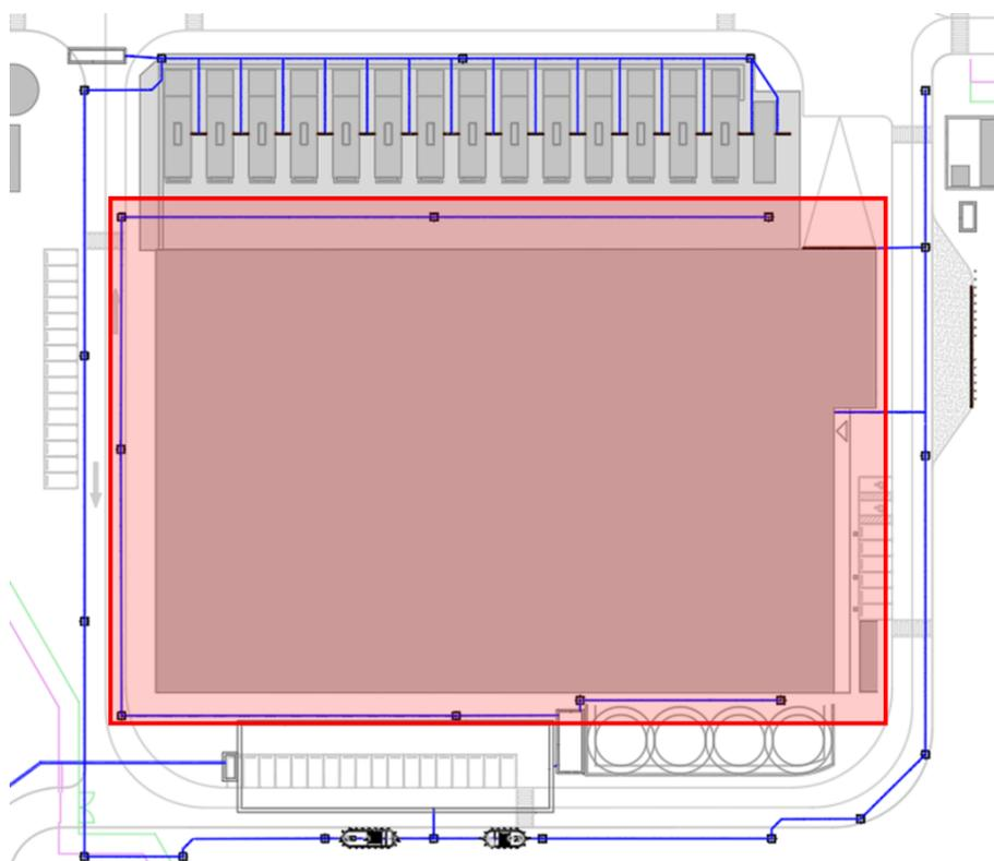
**Figura 15 - rete di collettamento acque meteoriche di copertura**
