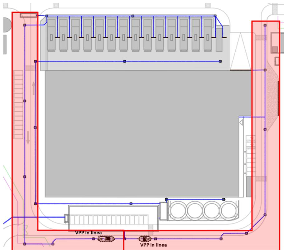
**Figura 12 - rete di collettamento acque meteoriche superfice stradale**
