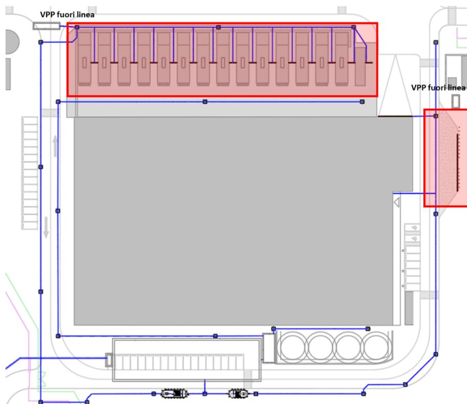
Figura 10 - rete collettamento acque meteoriche piazzale generatori e area rifornimento
