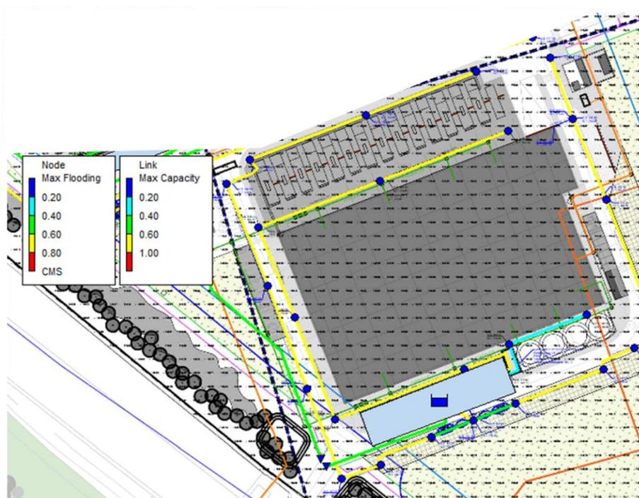
**Figura 19 - Massimi gradi di riempimento delle condotte e livello di allagamento ai nodi**
