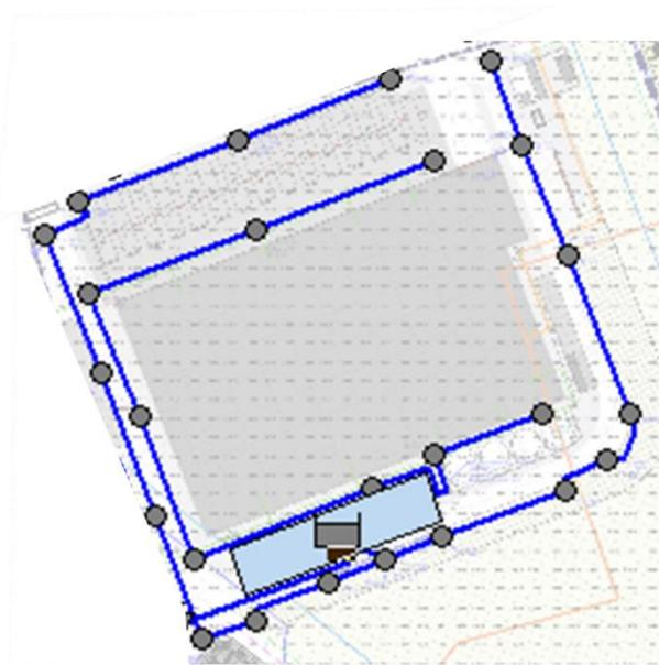
Figura 17 - Schema del modello in SWMM
