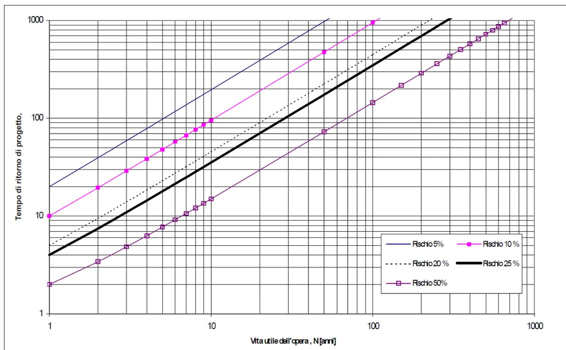
Figura 3 - Andamento del rischio idraulico al variare del  $Tr$  di progetto e della vita utile dell'opera
