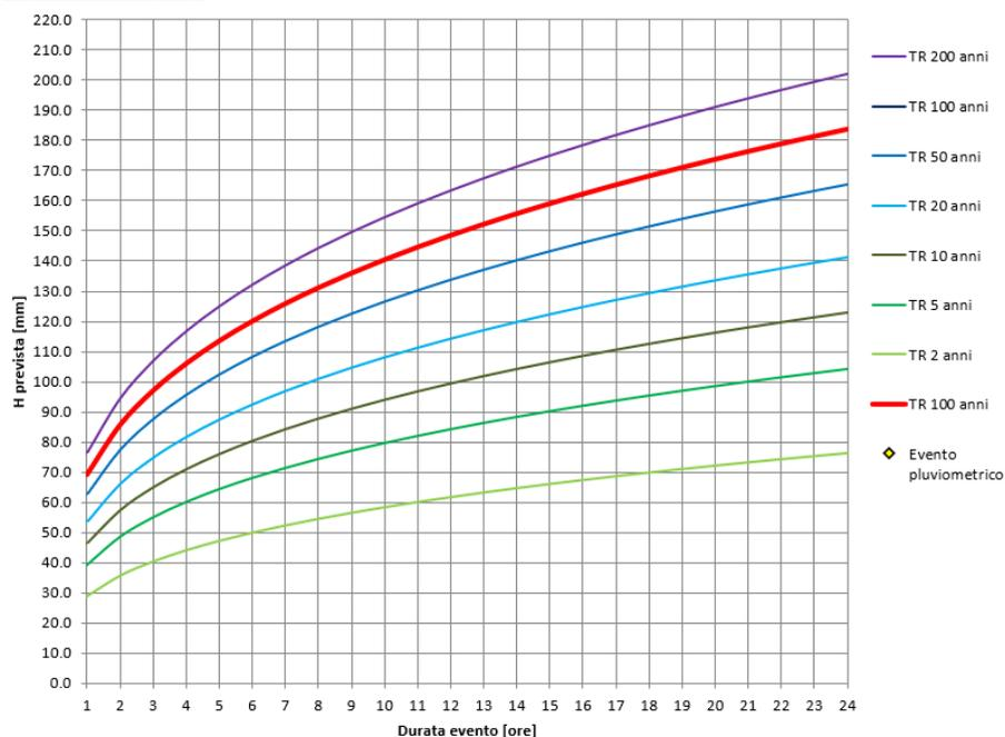
**Figura 4 - Linea segnalatrice di possibilità pluviometrica**
